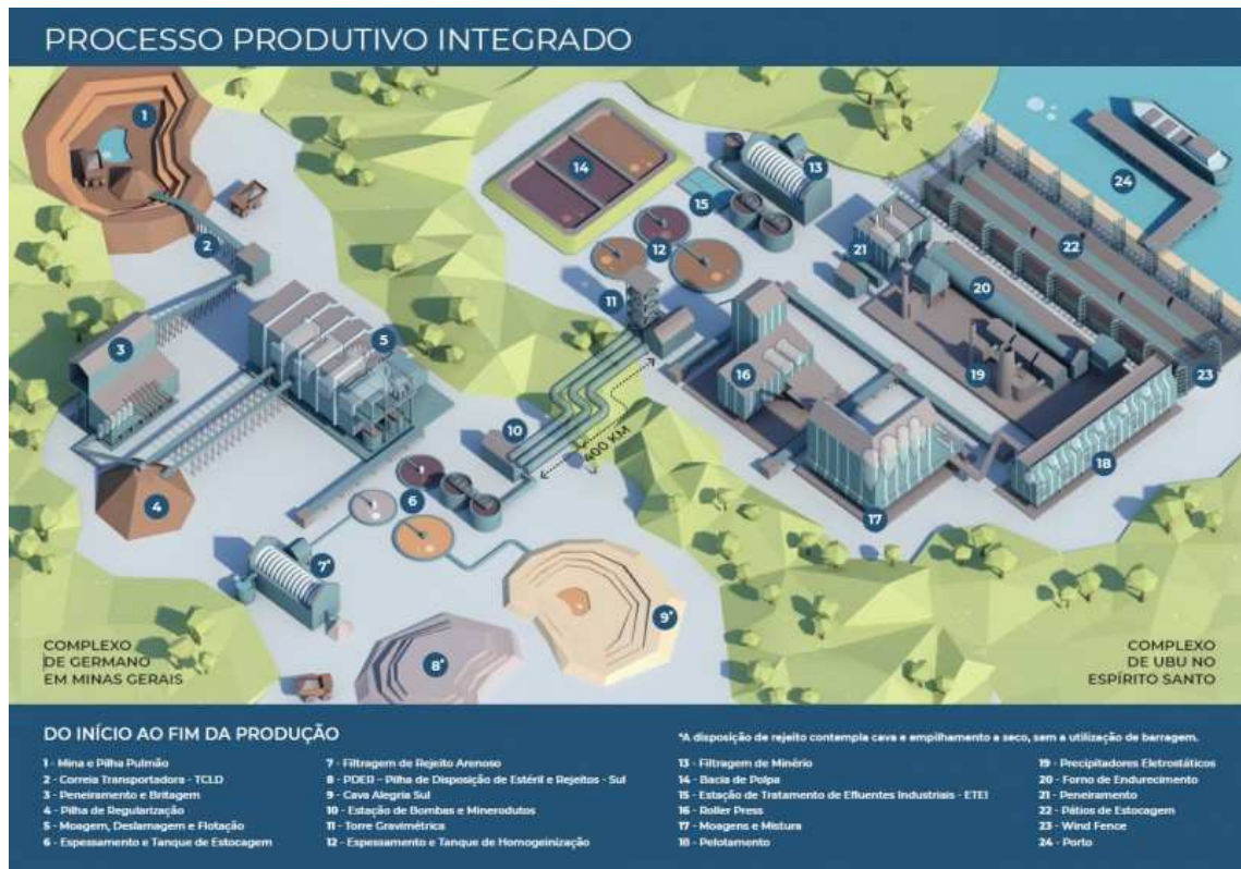
FIGURA 8 - Infográfico exhibe o processo produtivo integrado da Samarco
