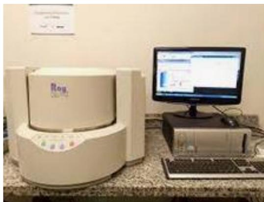
Figura 24. Espectrômetro de fluorescência de raios X.
