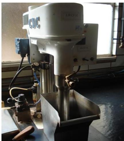
Figura 28. Célula de flotação em bancada, marca CDC, modelo CFE-100.
