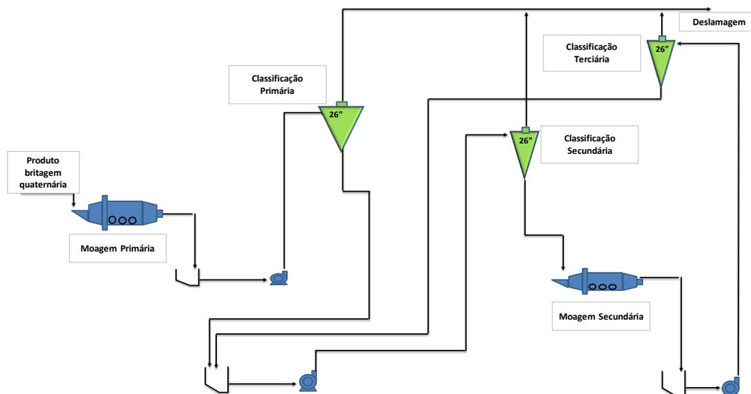
Figura 7. Fluxograma das instalações de moagem (VALE, 2021).
