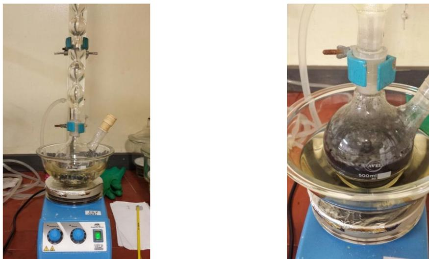
**Figura 15.** Esquema do sistema de refluxo utilizado nas lixiviações da bateria íon-lítio
