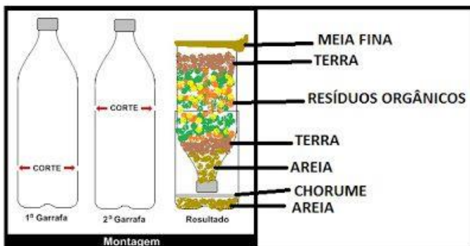
Figura 4-6 - Montagem da composteira.
