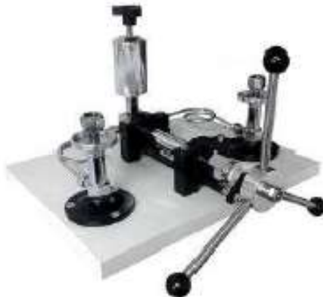
Figura 40 Bomba hidráulica para calibração dos transdutores de pressão.
