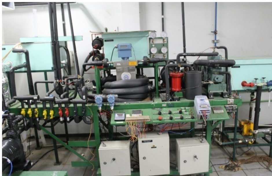
Figura 20: Circuito de refrigeração auxiliar.
