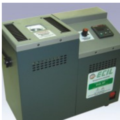
Figura 41 Forno de calibração utilizado
