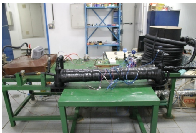
Figura 18: Seção de testes (condensador).
