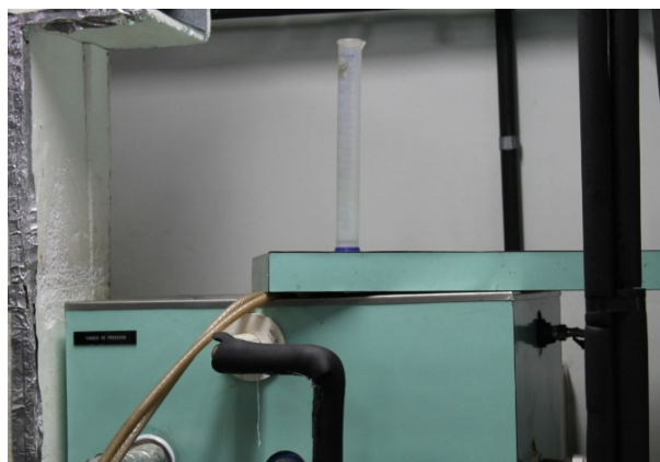
Figura 17: Bureta usada para medir vazão de água.
