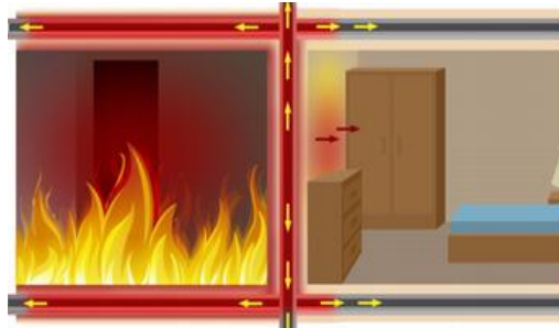
Figura 1 - Propagação de incêndio por condução (MARCONDES, 2020)
