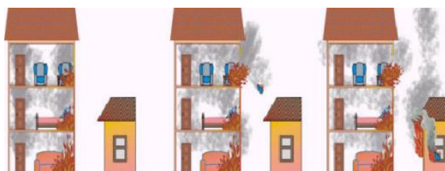
Figura 4 - Propagação de incêndio por projeção (CALDAS, 2021)
