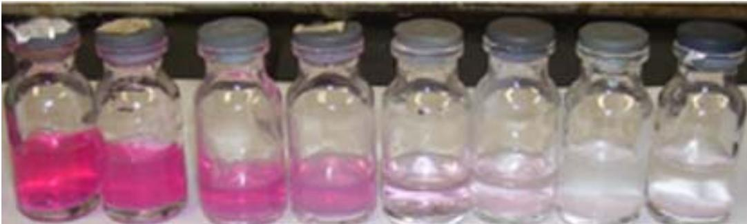
*Figura 4.11: Foto da fotodecomposição do corante vermelho de Drimaren pelo ZnO/TiO<sub>2</sub> 3%
