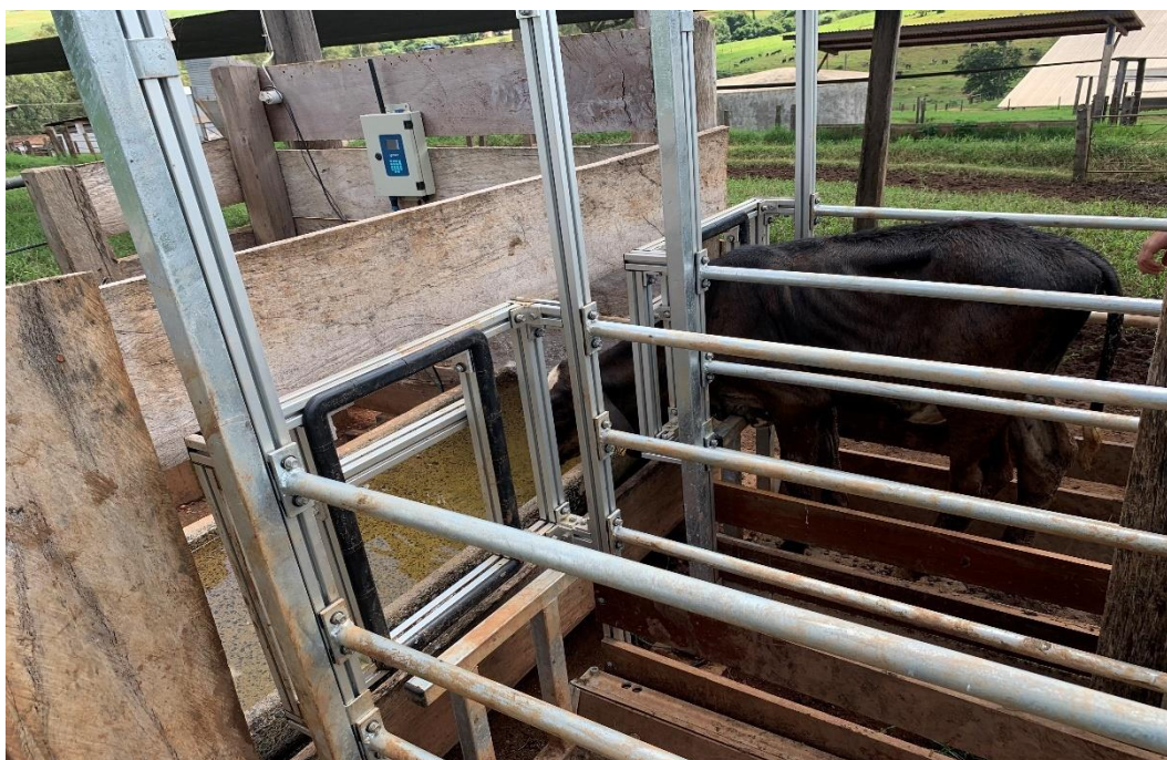
Figura 6: Sistema de pesagem voluntária através de balanças automáticas de precisão Intergado©.
