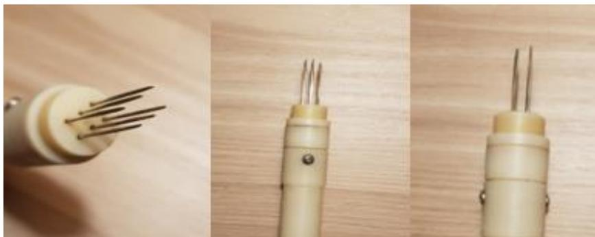
Figura 5 – Eletrodo em agulhas com duas fileiras de agulhas paralelas de aço inoxidável, com distância interna entre as fileiras de 5 mm.
