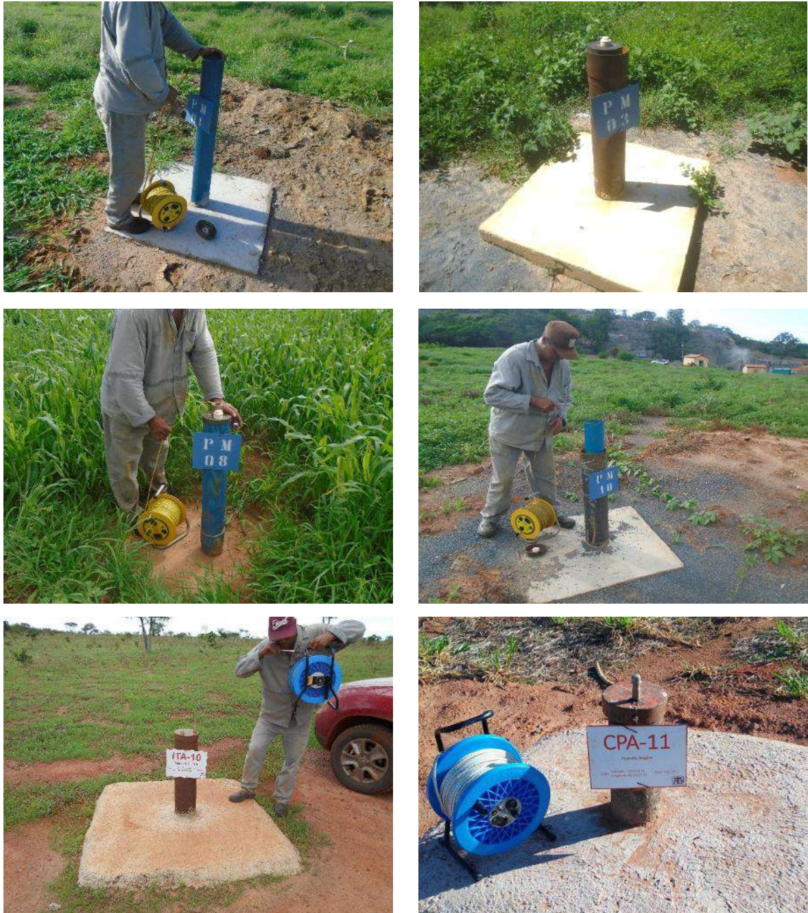
Foto 6: Poços da rede de monitoramento do nível d'água, no ato das leituras. Exemplos de poços novos, construídos em outubro de 2017 (PM's 01, 03, 08 e 10) e de antigos poços de bombeamento desativados, destinados exclusivamente ao monitoramento do nível d'água (ITA-10 e CPA-11).
