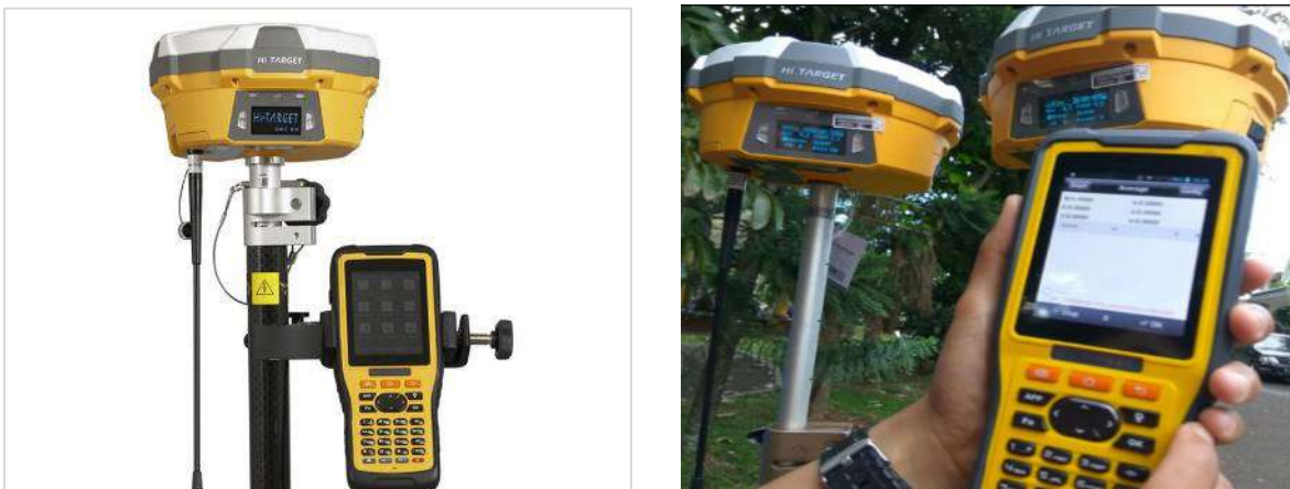
Foto 11: Equipamento GPS GNSS High Target V60 utilizado levantamento topográfico planialtimétrico da calha do rio Verde Grande pela Nedro (2020).
