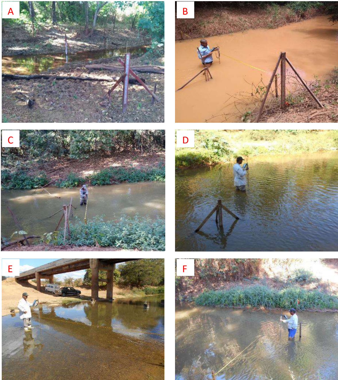
Foto 7: Estações Fluviométricas instaladas no riacho Salobro e no Rio Verde Grande. A) VZ-01 (salobro), B) VZ-02, C) VZ-03, D) VZ-05, E) VZ-06, F) VZ-07. (Fonte: acervo A.R.G).
