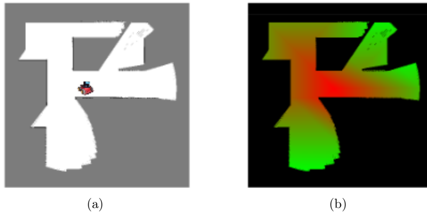
Figura 2.15: Exemplo de propagação de onda do algoritmo Wavefront Propagation usando um único robô [Colares & Chaimowicz, 2015].
