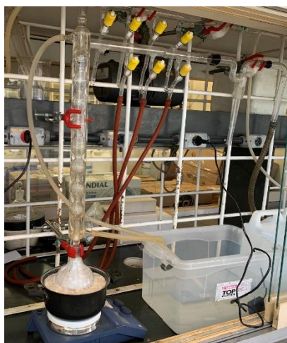
Figura 10 - Sistema utilizado para a modificação ácida das zeólitas. A água utilizada para resfriamento no condensador foi reciclada com o auxílio de uma bomba de aquário. Fonte: arquivo pessoal.
