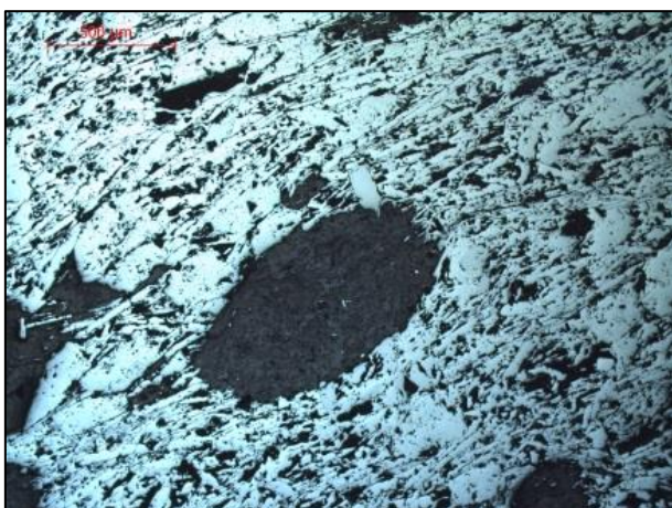
Foto 4.23 – Fotomicrografia sob luz refletida não polarizada de nódulo elíptico de mica branca que ocorre envolvido pela especularita em minério xistoso. Amostra JC-194. Local: Mina Oeste. UTM: 556428E/ 7771187N.
