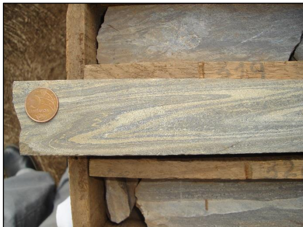
Foto 3.26 – Dobra isoclinal em itabirito da Fm. Cauê. Local: Mina Esperança. Testemunho de sondagem FD 024 (312 m).
