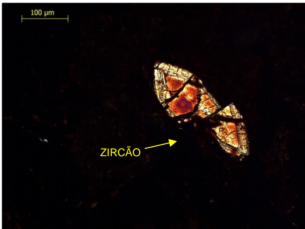
Foto 4.21 – Fotomicrografia sob luz transmitida polarizada mostrando grão de zircão zonado, subarredondado e fraturado que ocorre em veio de óxido de ferro encaixado em quartzito da Formação Cercadinho. Amostra JC-148. Local: Mina Leste: 565965E/7775177N.
