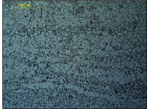
Foto 4.8 – Fotomicrografia sob luz refletida não polarizada de minério com bandamento marcado pela diferença de porosidade. As bandas escuras são mais porosas do que as claras. Amostra JC-163. Local: Mina Central. UTM: 559699E/7772912N
