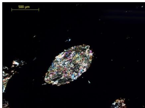
Foto 4.24 – Fotomicrografia sob luz transmitida polarizada de nódulo elíptico de mica branca que ocorre envolvido pela especularita em minério xistoso. Amostra JC-194. Local: Mina Oeste. UTM: 556428E/ 7771187N.
