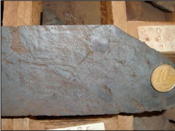
Foto 4.7 – Minério de ferro com bandamento preservado. Local: Mina Esperança. Testemunho de sondagem FD 008 (105 m de profundidade).
