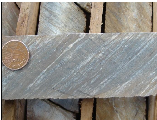
Foto 3.15 – Itabirito com bandamento descontínuo e difuso no interior de zona de cisalhamento. Local: Mina Esperança. Testemunho de sondagem FD 009 (221 m).
