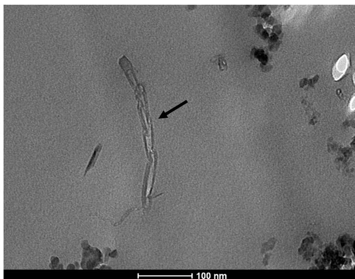
Figura 64 – Defeitos no nanotubos de carbono em uma amostra de 1,0% m/m MWCNT-epóxi.
