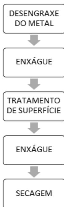
Figura 14. Fluxograma de preparação de superfícies de metais. (Fonte: adaptado de POCIUS, 2021).
