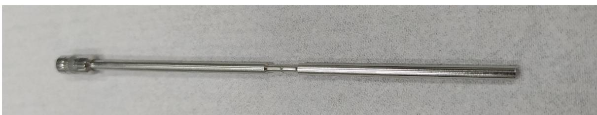
Figura 35. Spindle 7 para medição de viscosidade. (Fonte: o autor).
