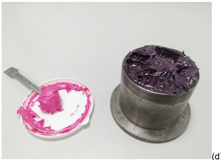
Figura 31. Nanocompósitos produzidos com a Placa 1. À esquerda, adesivo epóxi puro; à direita (a) 0,1% m/m MWCNT-epóxi (b) 0,25% m/m MWCNT-epóxi (c) 0,5% m/m MWCNT-epóxi (d) 1,0% m/m MWCNT-epóxi. (Fonte: o autor).
