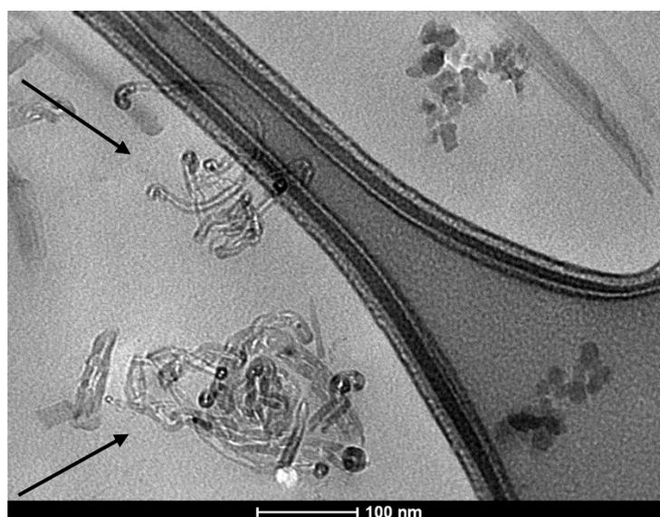
Figura 65 – Aglomerados de nanotubos de carbono em uma amostra de 1,0% m/m MWCNT-epóxi.
