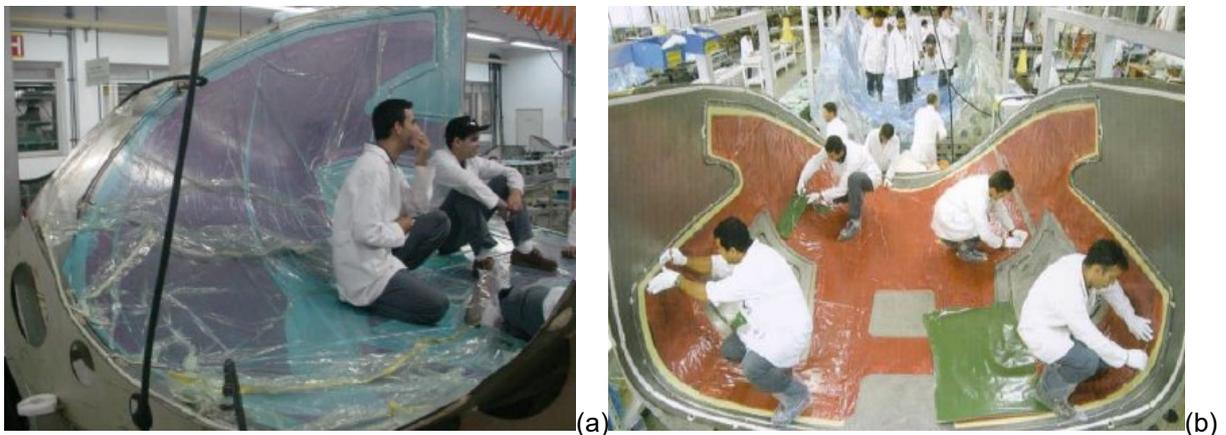
Figura 3. Pavimento de uma aeronave sendo adesivado. (Fonte: 3M, 2019).
