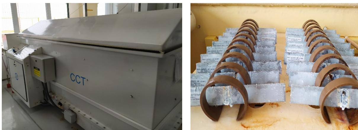
Figura 47. Câmara de névoa salina (a) e (b) vista dos corpos de prova. (Fonte: o autor).
