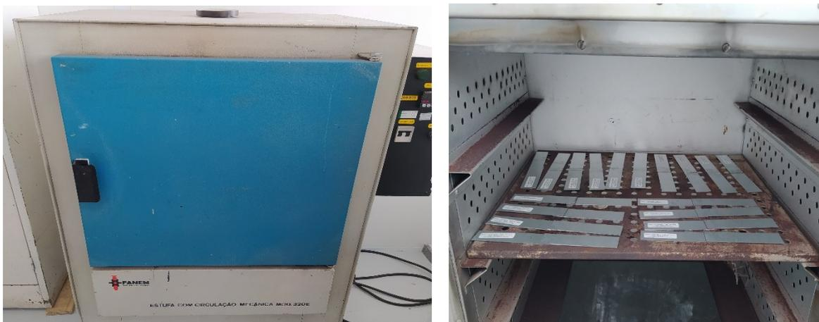
Figura 45. Estufa (a) e (b) corpos de prova no interior da estufa. (Fonte: o autor).
