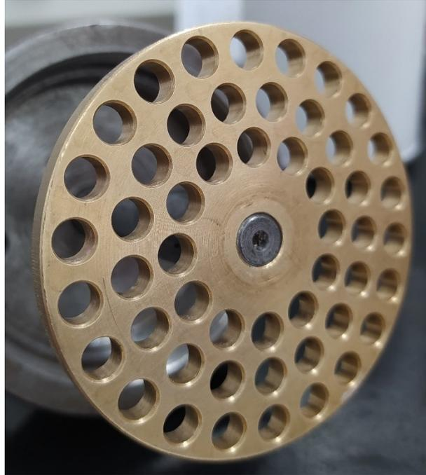
Figura 29. Placa perfurada conforme ASTM D217 – Placa 1. (Fonte: o autor).
