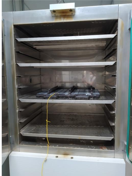
*Figura 43. Estufa para cura dos corpos de prova com termopares fixados. (Fonte: o autor).*
