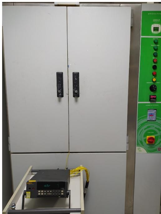
Figura 44. Estufa com dispositivo para controle de temperatura. (Fonte: o autor).
