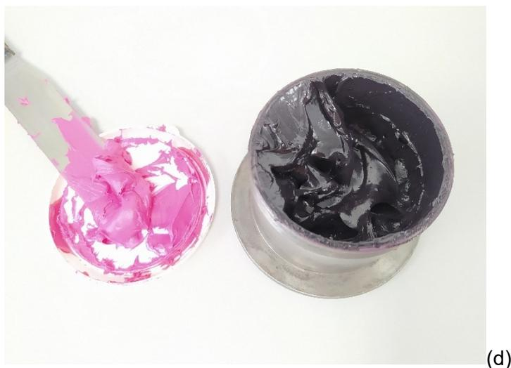
Figura 34. Nanocompósitos produzidos com a Placa 2. A esquerda, adesivo epóxi puro; a direita (a) 0,1% m/m MWCNT-epóxi (b) 0,25% m/m MWCNT-epóxi (c) 0,5% m/m MWCNT-epóxi (d) 1,0% m/m MWCNT-epóxi. (Fonte: o autor).
