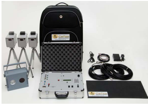
FIGURA 3 – Fotocélulas para avaliação da velocidade da corrida ( Speed Test )
