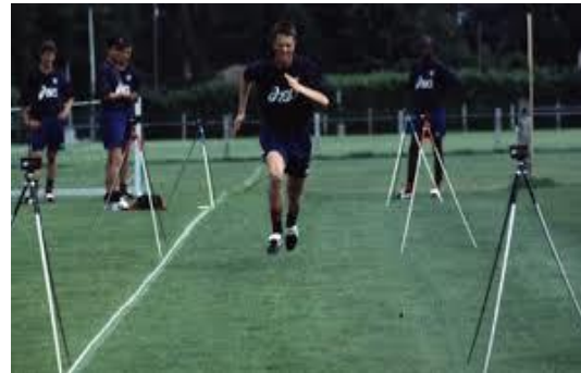
FIGURA 3 – Fotocélulas para avaliação da velocidade da corrida ( Speed Test )
