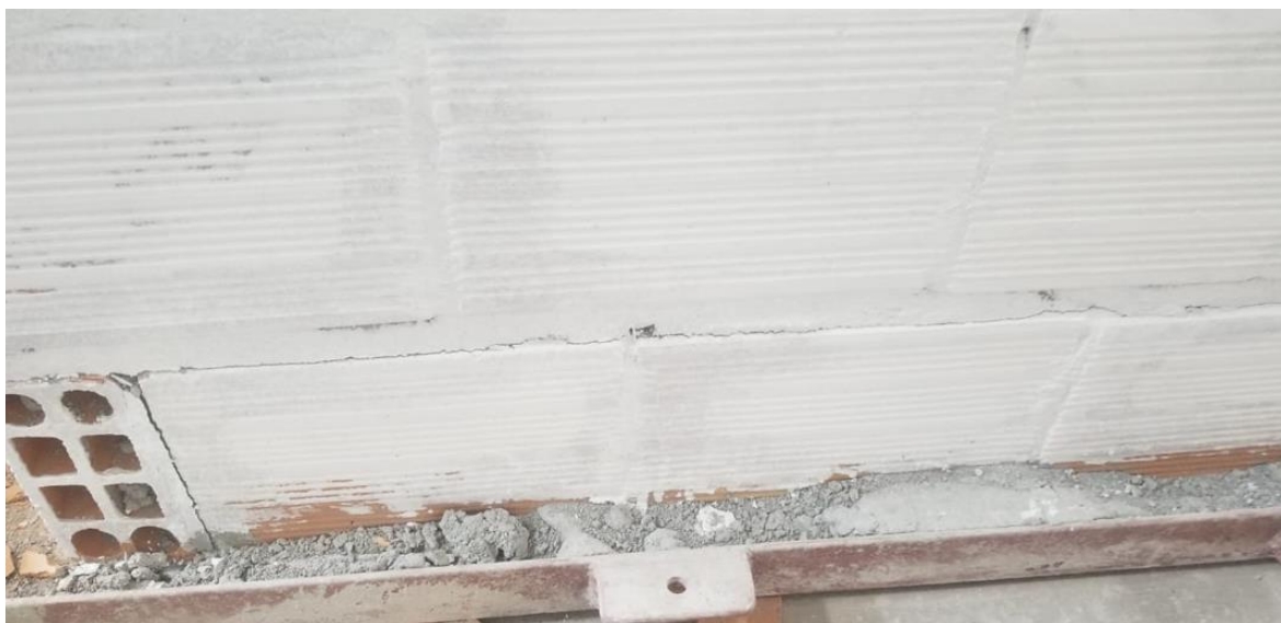
Figura 110 – Ruína na base da segunda ALV- 6 após o impacto de 720 J
