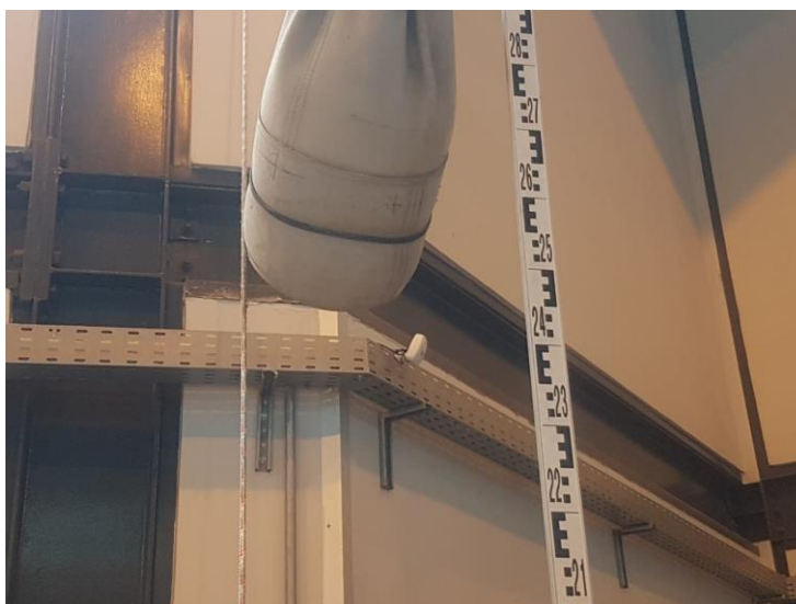
Figura 46 – Auxílio da utilização da mira topográfica adaptada para aferição das alturas com as respectivas energias de impacto
