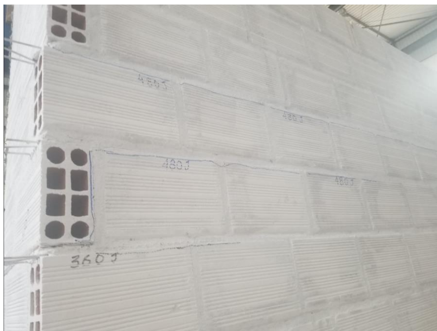
Figura 94 – Vista ampliada da ALV- 6 após os impactos de 360 e 480 J
