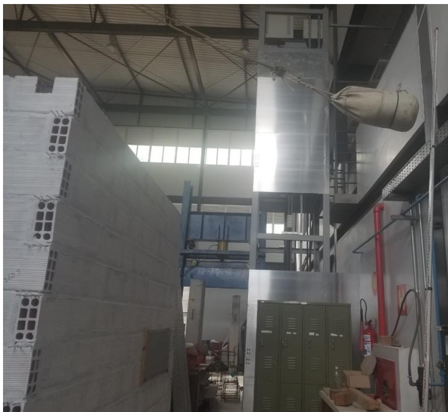
Figura 95 – Preparação antes da realização do ensaio de impacto de corpo mole de 720
