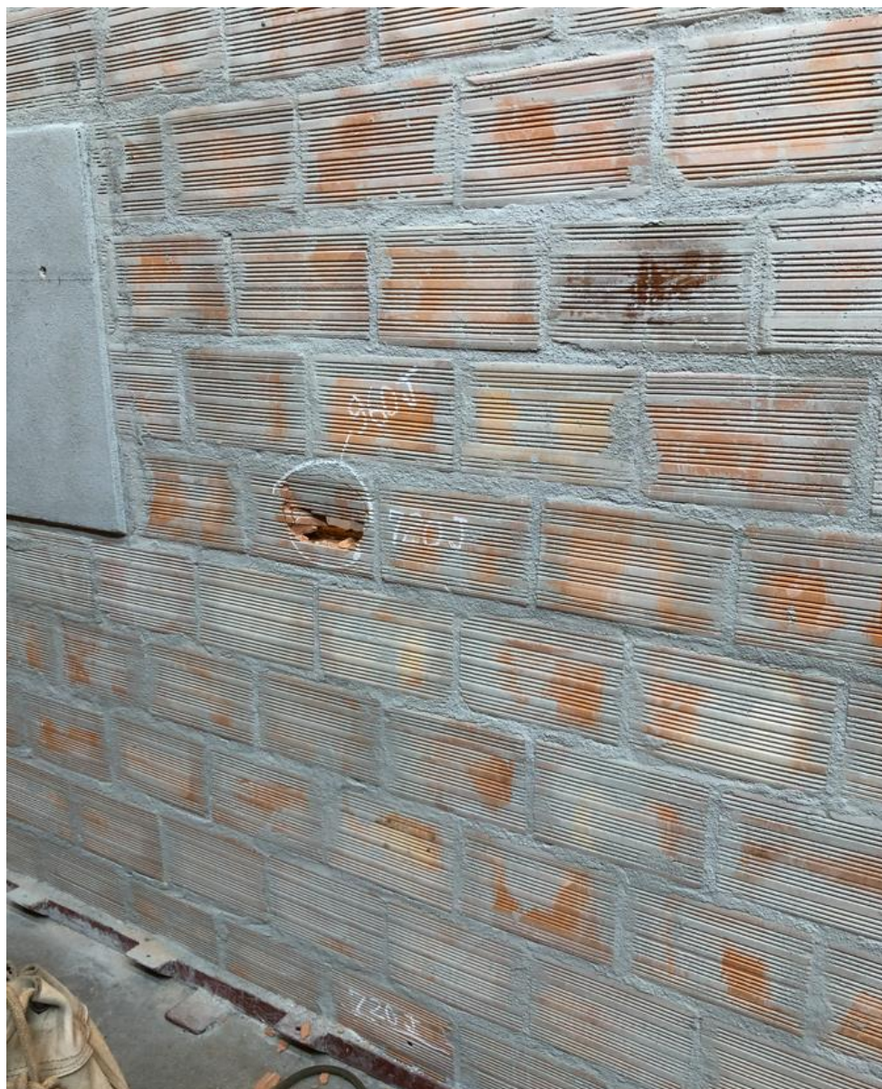
Figura 69 – Resultado final após a realização de todos os impactos
