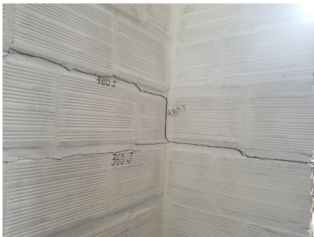
Figura 84 – Vista traseira após a realização do 6º impacto de corpo mole
