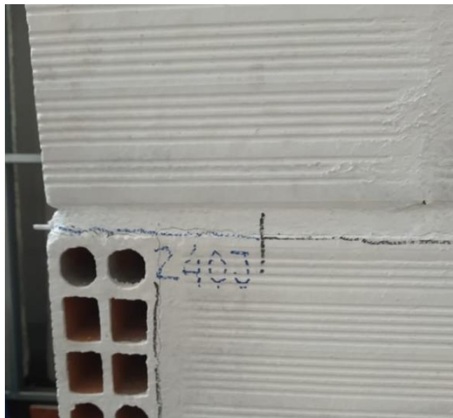
Figura 102 – Fissura frontal em azul após o impacto para a energia de 240 J
