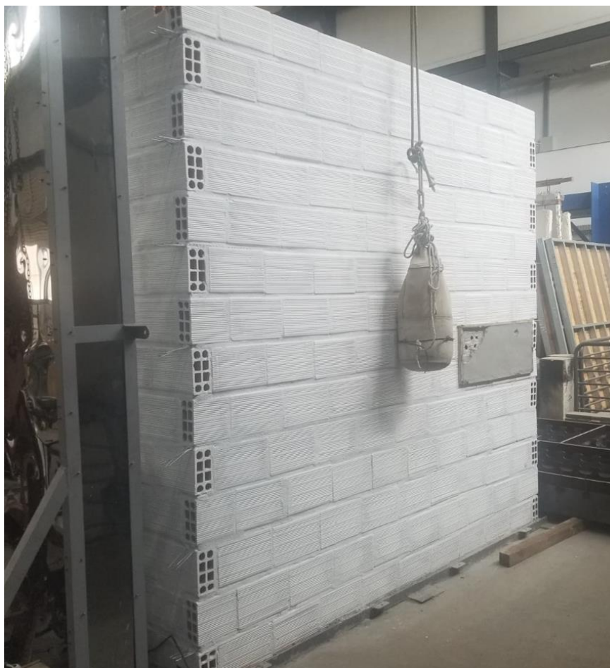
Figura 85 – Vista frontal antes da realização dos ensaios de impacto de corpo mole
