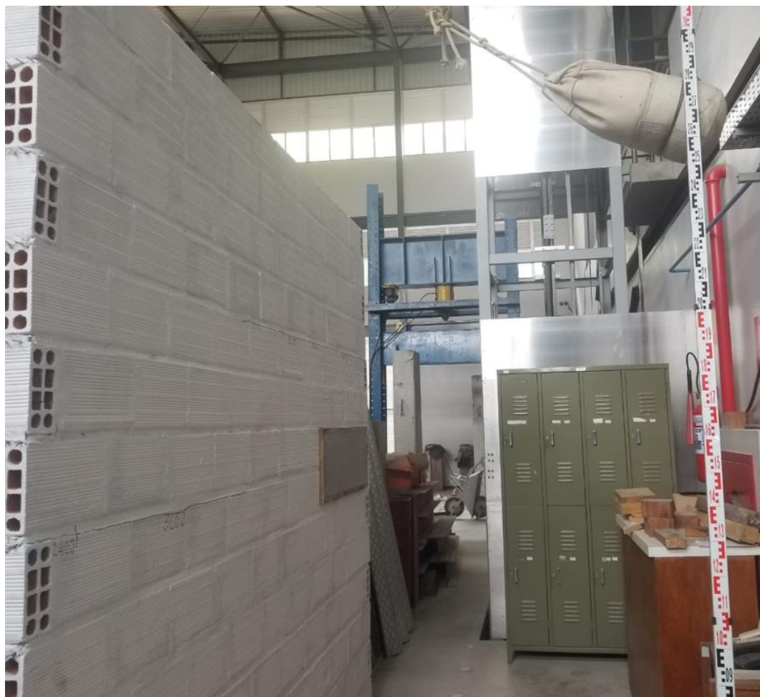
Figura 104 – Vista lateral da segunda ALV – 6 antes da realização do ensaio de impacto de corpo mole para a energia de 480 J
