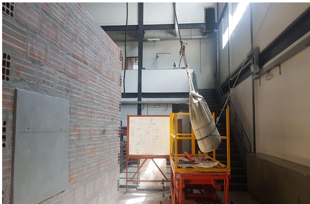
Figura 63 – Vista lateral da realização do ensaio de impacto de corpo mole
