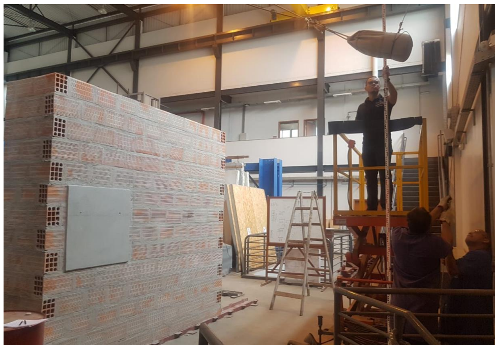
Figura 67 – Preparação para o ensaio de impacto de corpo mole na altura desejada
