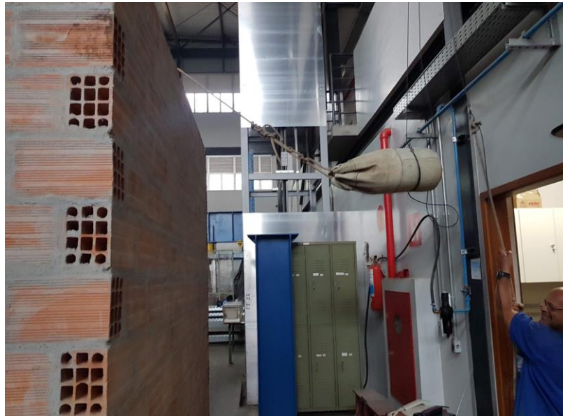
Figura 47 – Auxílio de roldanas para elevação do saco de corpo mole na altura desejada
