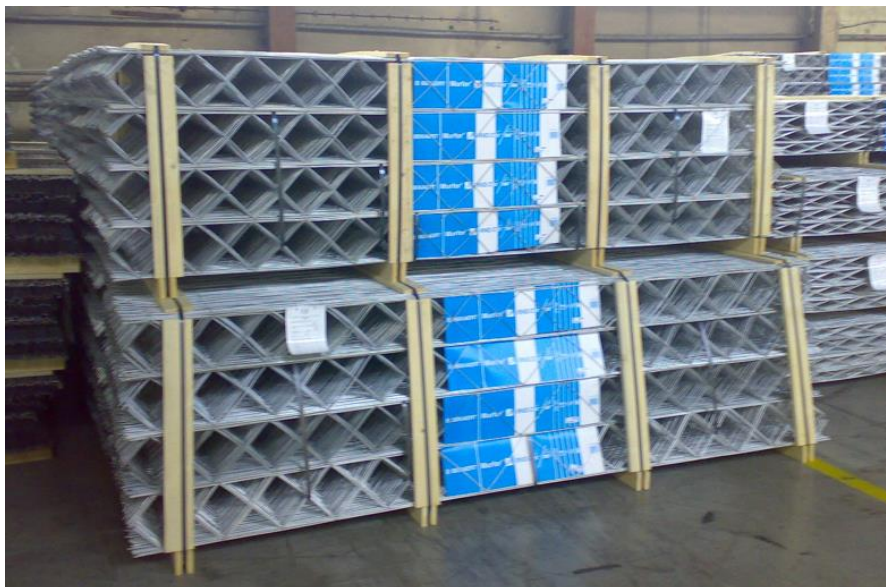
Figura 19 – Feixes de treliças planas galvanizadas armazenadas
