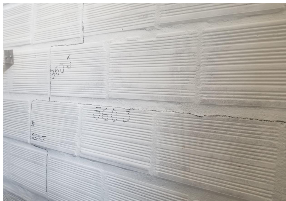
Figura 82 – Vista posterior após a realização do 5º impacto de corpo mole
