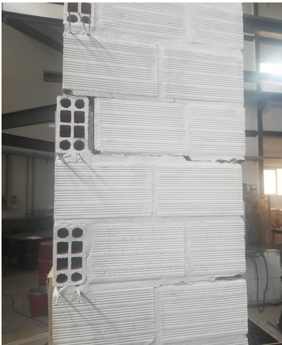
Figura 91 – Deslizamento da alvenaria na direção da sua própria junta horizontal com a vista lateral
