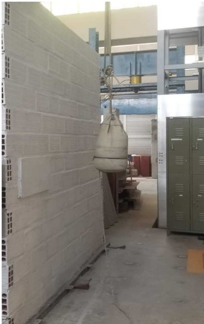
Figura 80 – Vista lateral da realização do ensaio de impacto de corpo mole
