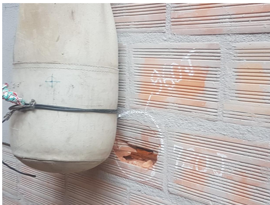
Figura 68 – Ruptura localizada no bloco após impacto de 960 J
