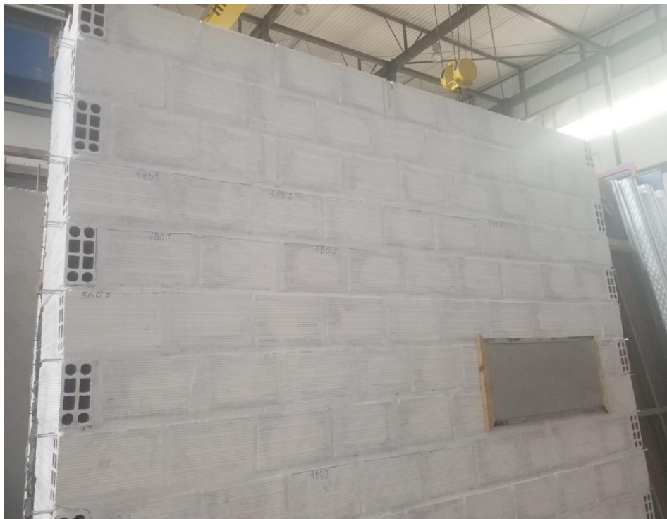
Figura 93 – Vista da ALV- 6 após os impactos de 360 e 480 J
