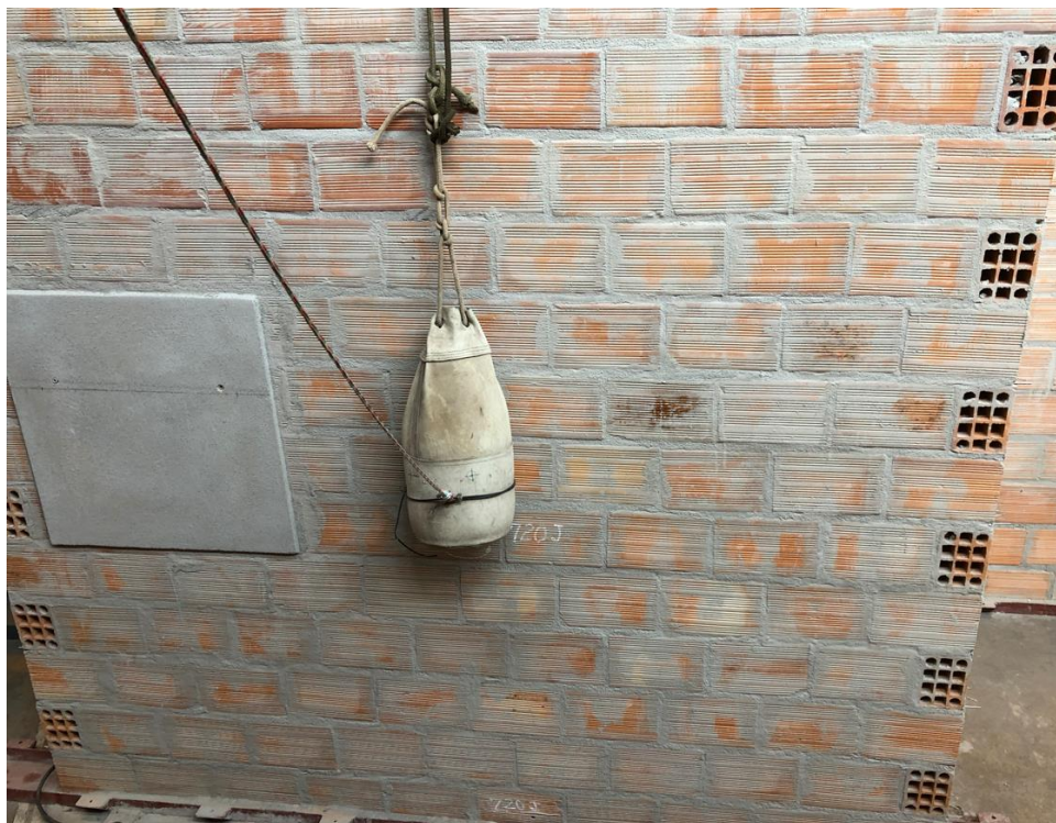
Figura 66 – Ruptura localizada e fissura na base após impacto de 720 J
