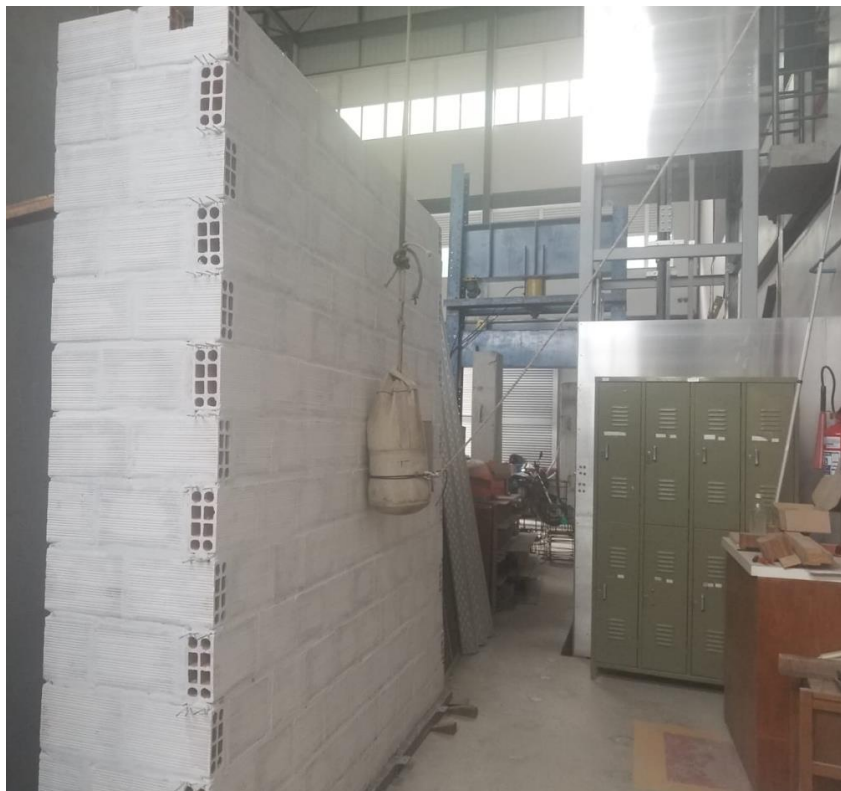
Figura 92 – Vista lateral da ALV – 6 antes da realização do ensaio de impacto de corpo mole
