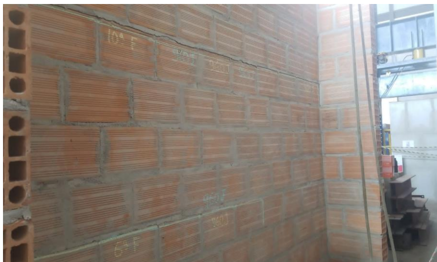
Figura 76 – Vista posterior para a fissura apresentada na junta horizontal da 6ª e 10ª fiada
