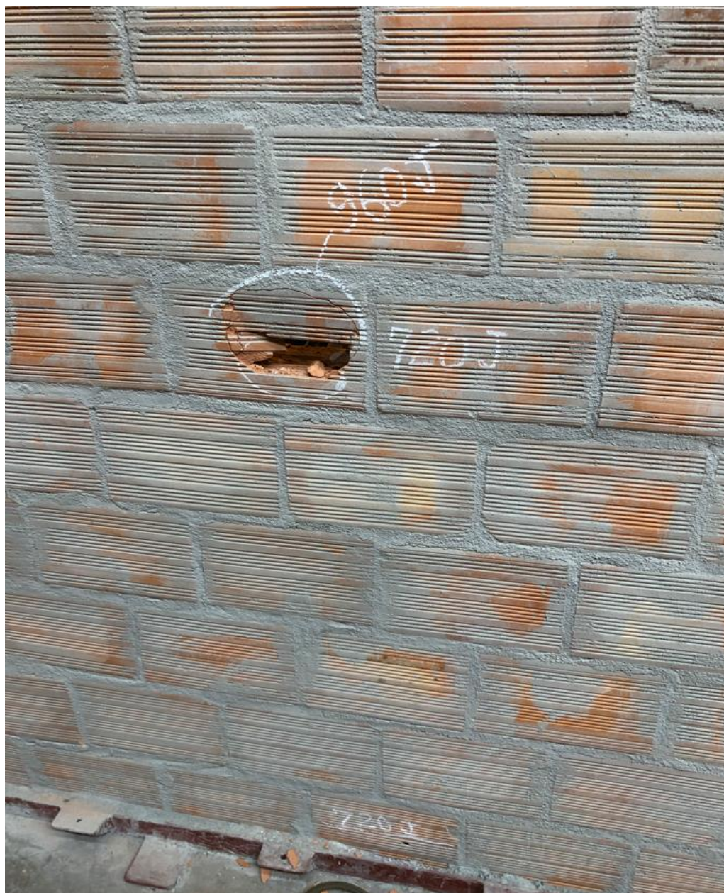
Figura 70 – Resultado final após a realização de todos os impactos em vista ampliada
