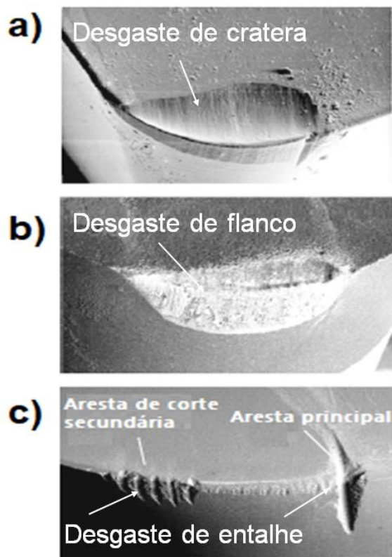
FIGURA 2.6 - Tipos de desgaste: a) desgaste de cratera, b) desgaste de flanco e c) desgaste de entalhe.
