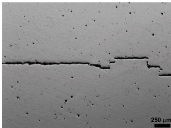
Figura 3.6 Tubo API 5LX65 com fratura induzida por hidrogênio [39].
