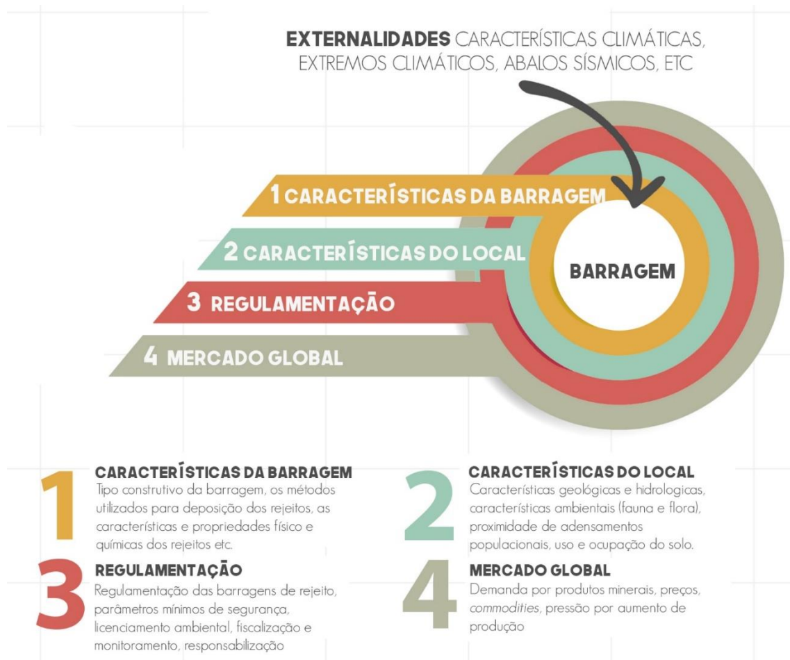
Figura 9. Framework – Determinantes não-sociais que influenciam a situação de estabilidade da barragem e seus possíveis impactos em caso de rompimento ou falha.
