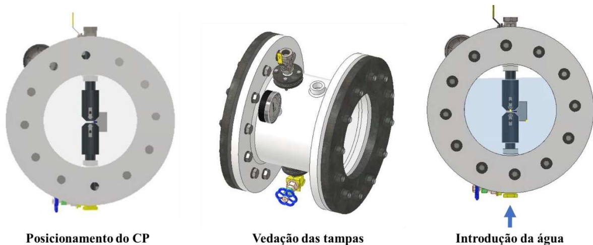
Figura 4.7 – Esquema de introdução da água na câmara hiperbárica.
