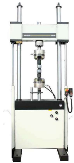
Figura 4.4 – Máquina Instron modelo 8802 utilizada no ensaio.
