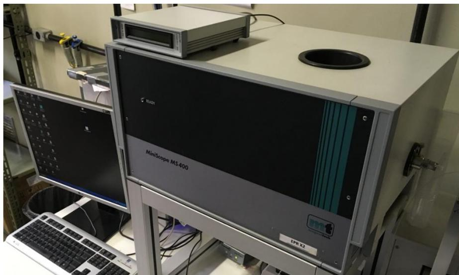
**Figura 10:** Espectrômetro de EPR da empresa Magnettech.
