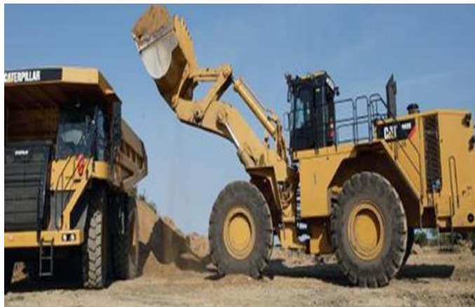
Figura 4: Carregadeira de pneus efetuando carregamento. Fonte: Vale, 2015, s. p.
