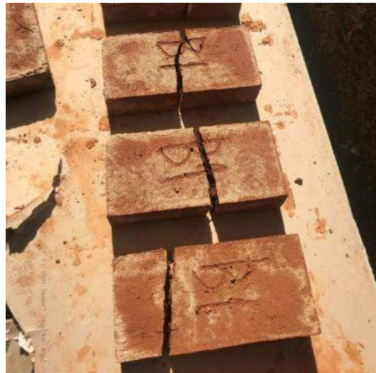
Figura 42 – Adobes trincados após secagem direta ao sol
