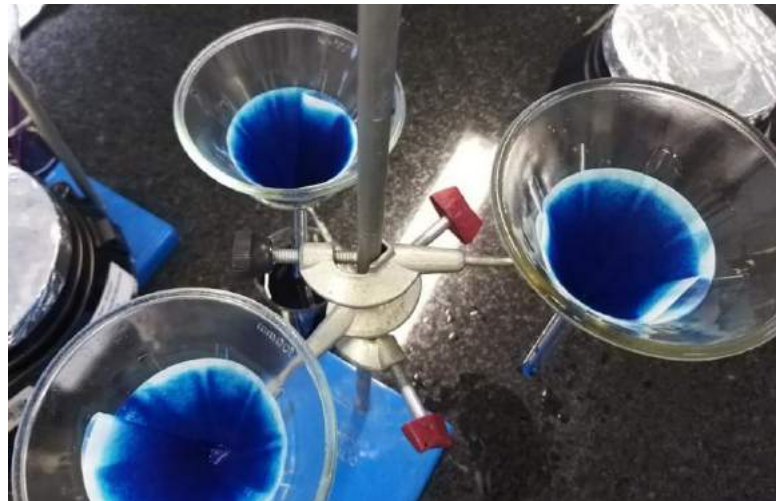
Figura 31 – Demonstração da retenção de azul de metileno pelo filtro de papel
