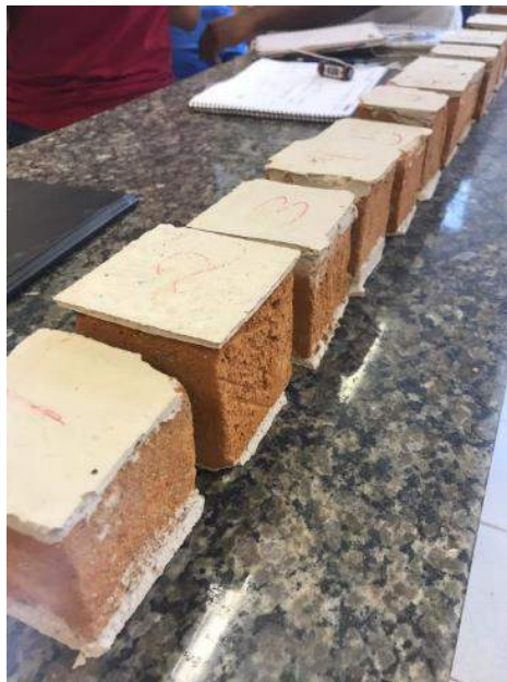
Figura 49 – Corpos de prova capeados
