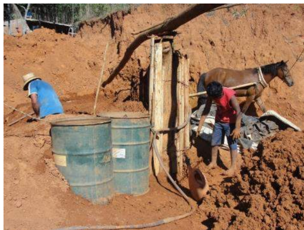
Figura 5 – Exemplo de pipa de tração animal usada para preparação da massa do adobe
