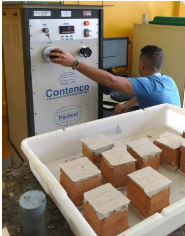
Figura 51 – Realização do ensaio de resistência à compressão
