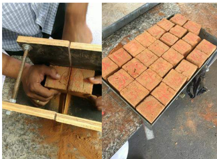
Figura 48 – Gabarito de madeira para corte e corpos de prova cortados
