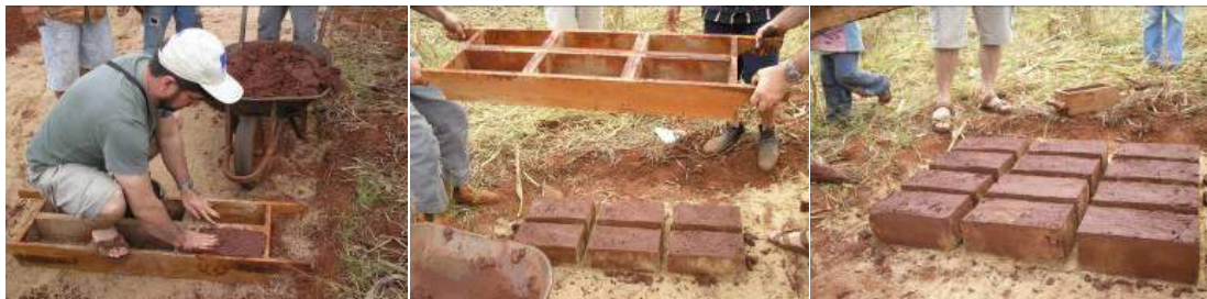
Figura 7 – Exemplo de moldagem do adobe com forma de seis blocos
