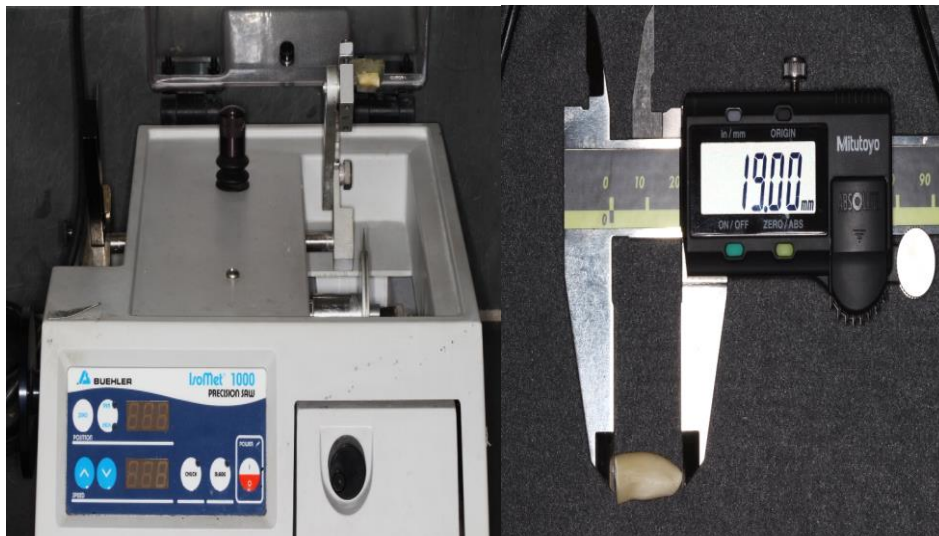
Figura 6 – Máquina de corte utilizada Isomet 1000 (Buehler)
