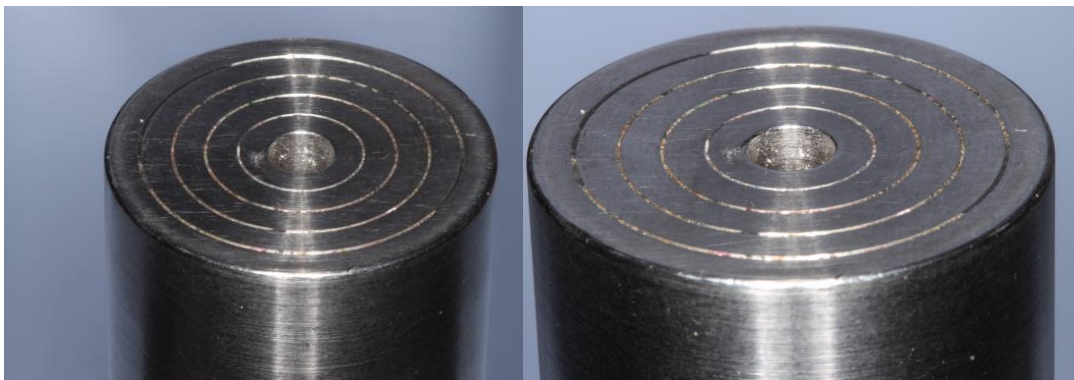
Figura 28 – Dispositivo com orifício central utilizado para o teste de push out como base para o apoio dos espécimes
