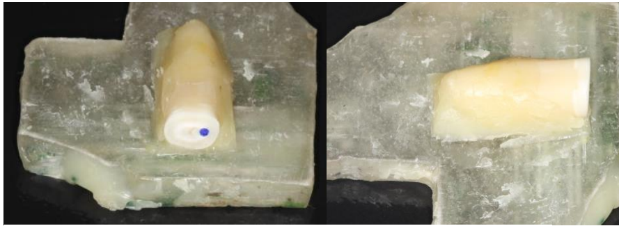
Figura 22 – Fixação da raiz em cera de baixa fusão na base de acrílico específica da máquina de cortes
