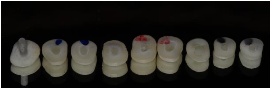
Figura 24 – Discos obtidos após o corte na Isomet. Terço cervical (azul), médio (vermelho) e apical (preto). O primeiro disco de cada terço foi desprezado (sem marcação)
