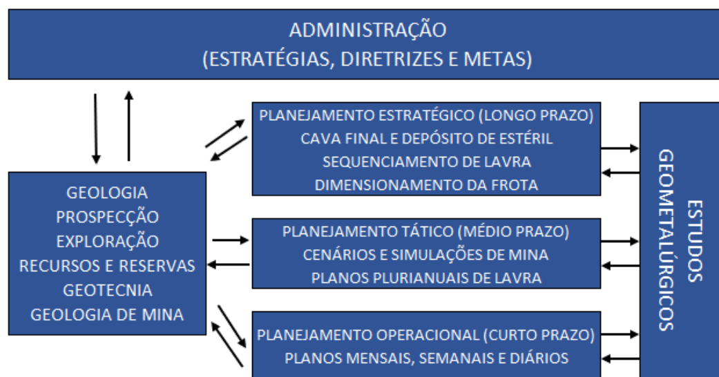
Figura 2.7 – Inter-relação entre planejamento de lavra e estudos geometalúrgicos (Adaptado de CURI, 2014)
