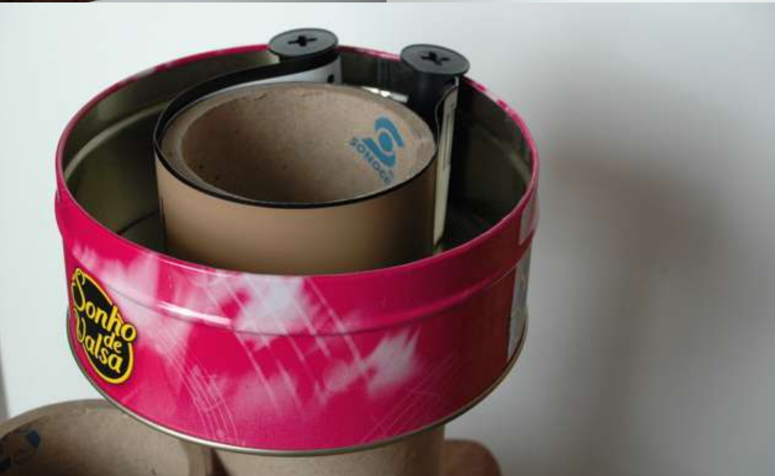
Figura 03 – Câmera feita de lata de bombom e sua estrutura circular com três orifícios e seu sistema de acionamento sincronizado. Fotografia digital. Acervo do autor
