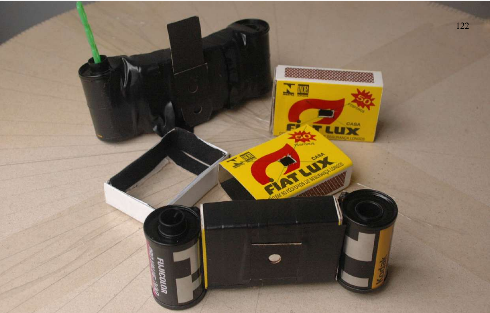
Figura 12 – câmera pinhole construída a partir da reutilização pequenas caixas de fósforos. Fotografia digital. Acervo do autor.
