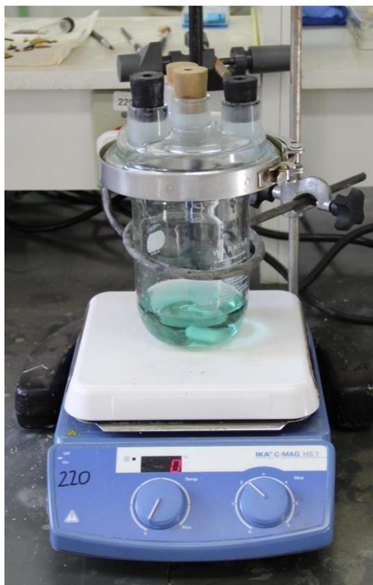
Figura 4-2 - Aparato experimental utilizado nos ensaios de lixiviação.
