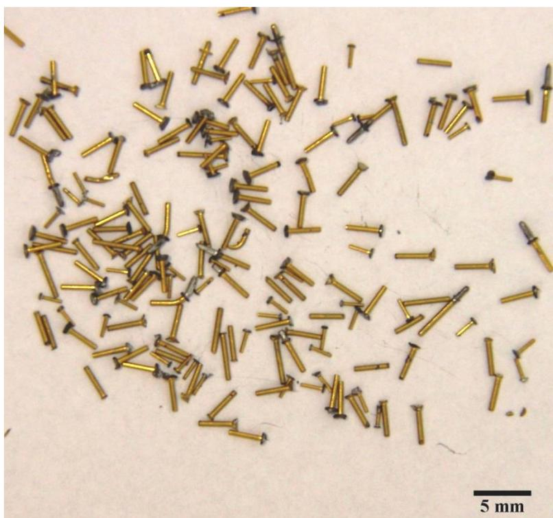
Figura 5-1 - Fotografia típica da amostra final de pinos conectores preparada no presente trabalho.
