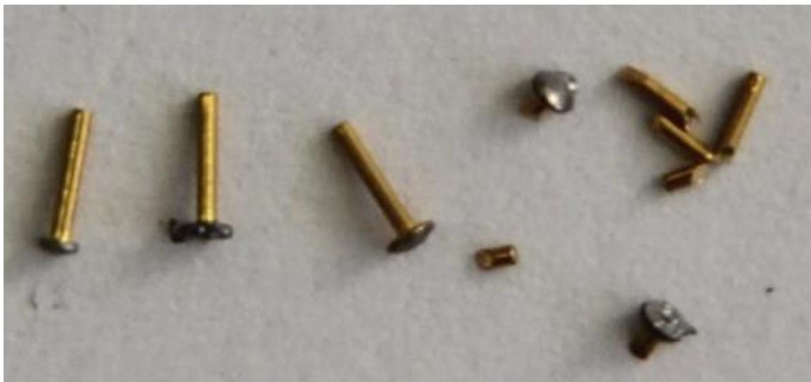
Figura 4-1 - Fotografia de pinos conectores. À esquerda: Pinos inteiros; À direita: seções de pinos obtidos por corte manual.
