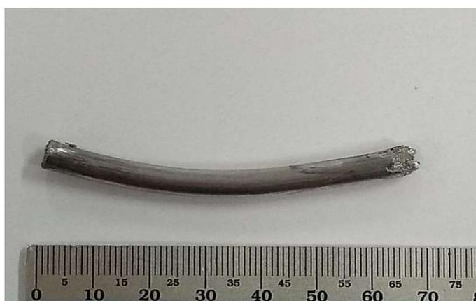
Figura 8.13- Compósito 0,5%<sub>m</sub> CNT/AA7050 prensado e extrudado a 350°C.
