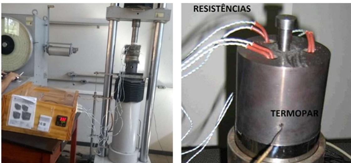
Figura 4.3 - Imagens (a) sistema de prensagem/extrusão envolto em manta de fibra de vidro e acoplado ao sistema de aquecimento e (b) detalhe da matriz com as resistências e termopar.
