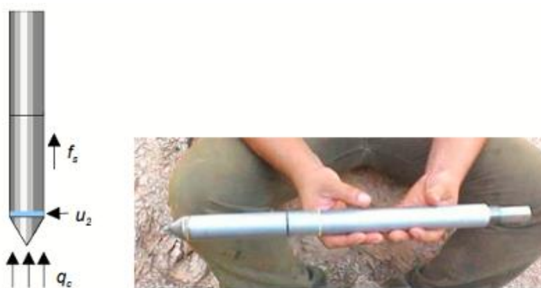
Figura 12. Piezocone, equipamento utilizado no ensaio CPTU. Fonte: Ortigão (2007)
