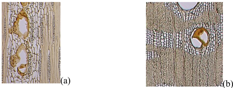
Figura 2.4 – Gomas- depósitos em seções de angelim-pedra: (a) Tangencial, (b) Transversal.
