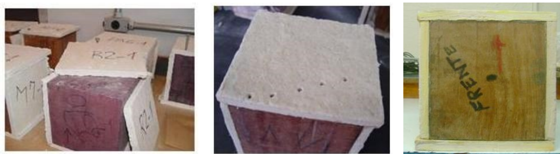
Figura 3.8 – Modo de preparação e isolamento dos corpos de prova.
