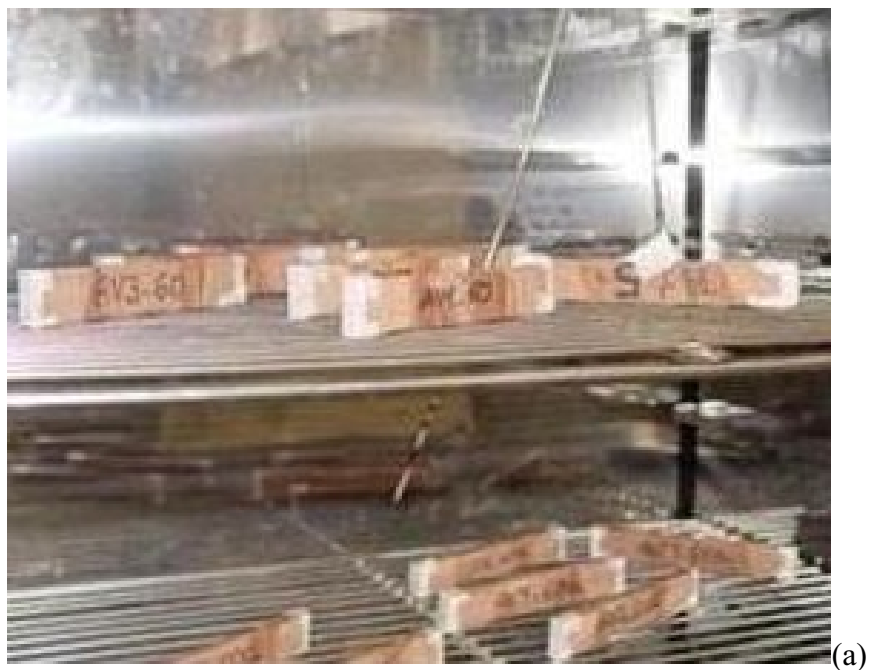
Figura 3.12 – Aquecimento de corpos de prova de tração: (a) na estufa e (b) no mufla.
