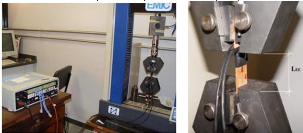
Figura D.1 – Montagem do ensaio de tração paralela às fibras (esq.) e detalhe do corpo de prova de tração instrumentado (à dir.).
