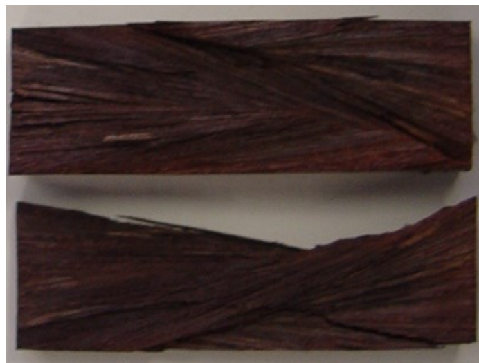
Figura 4.27 – Desvio da grã na Dinizia excelsa Ducke - angelim-vermelho.
