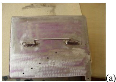
Figura 3.4 – Suporte: (a) com 5 furos e 1 aba lateral; (b) com 5 furos e 5 abas frontais.
