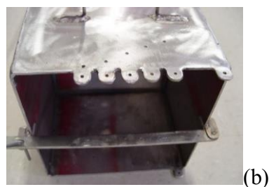
Figura 3.4 – Suporte: (a) com 5 furos e 1 aba lateral; (b) com 5 furos e 5 abas frontais.
