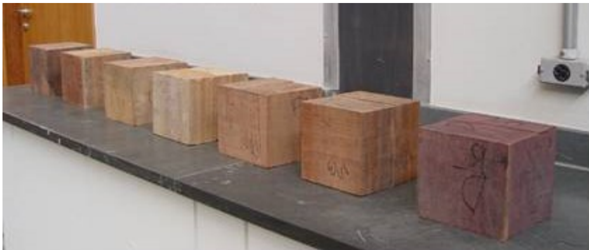
Figura 3.2 – Imagens dos corpos de prova de sete das treze espécies estudadas.
