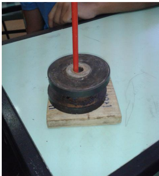
Fotografia 2 - Protótipo criado usando uma base de madeira, imãs e um lápis
