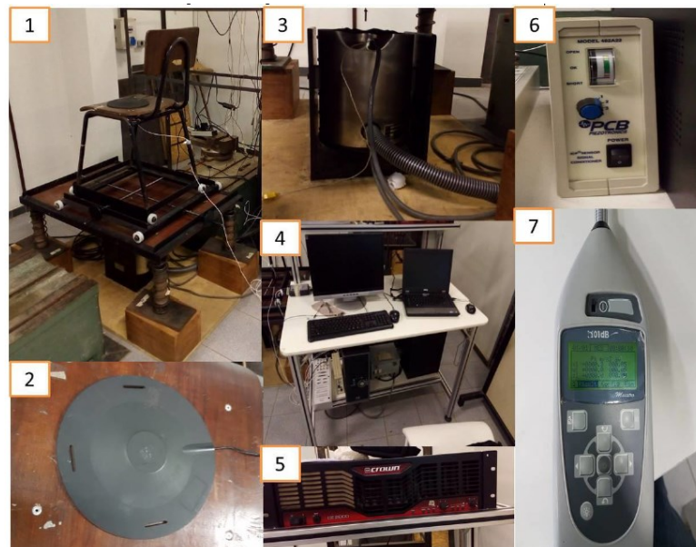
Figura 11: 1. Plataforma em aço; 2. Acelerômetro de assento; 3. Excitador eletromecânico; 4. Sistema de controle; 5. Amplificador de potência; 6. Condicionador de sinais; 7. Analisador de sinais de vibração humana - Maestro.
