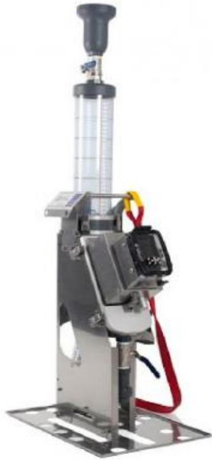
Figura 4. 2 – (a) Medidor de tamanho de bolhas Bubble Sizer APBS. (b) Montagem com o equipamento acoplado à célula de flotação em bancada.
