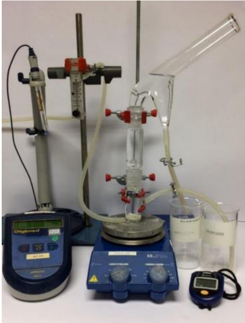
Figura 4. 1 - Montagem experimental do Tubo de Halimond modificado, pHmetro e cronômetro.
