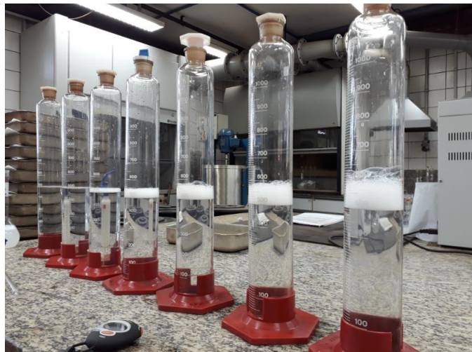
Figura 4. 3 – (a) Célula de flotação em bancada e (b) série de provetas graduadas para determinação de estabilidade de espuma via testes bifásicos (líquido-gás).
