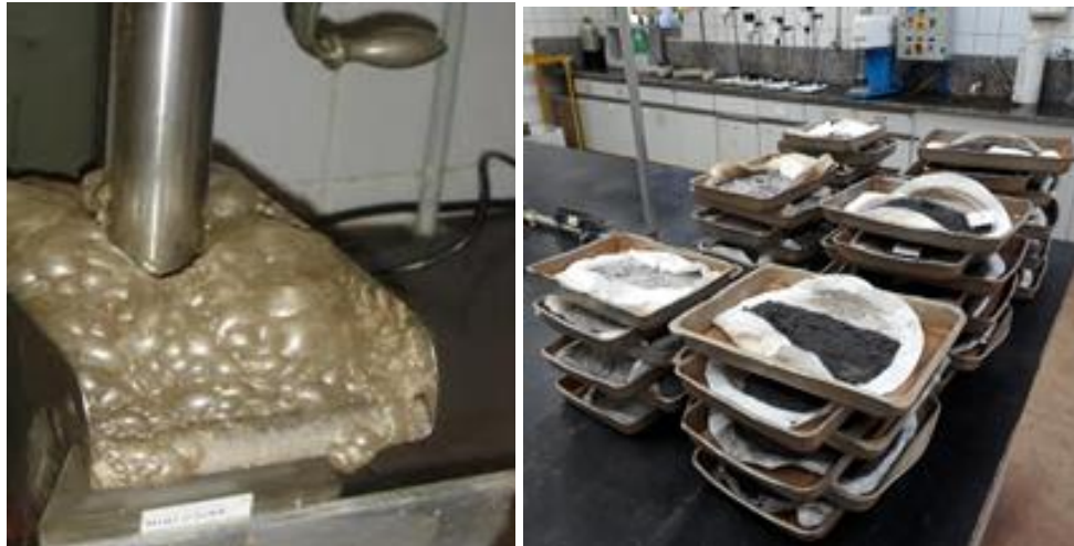
Figura 4. 4 – (a) Célula de flotação em bancada para realização de testes trifásicos (sólido-líquido-gás). (b) – detalhe das amostras de concentrado e rejeito após filtragem e secagem.
