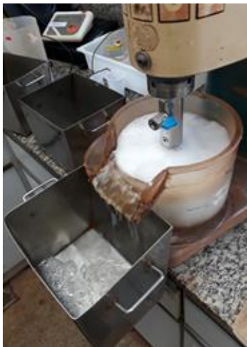
Figura 4. 3 – (a) Célula de flotação em bancada e (b) série de provetas graduadas para determinação de estabilidade de espuma via testes bifásicos (líquido-gás).
