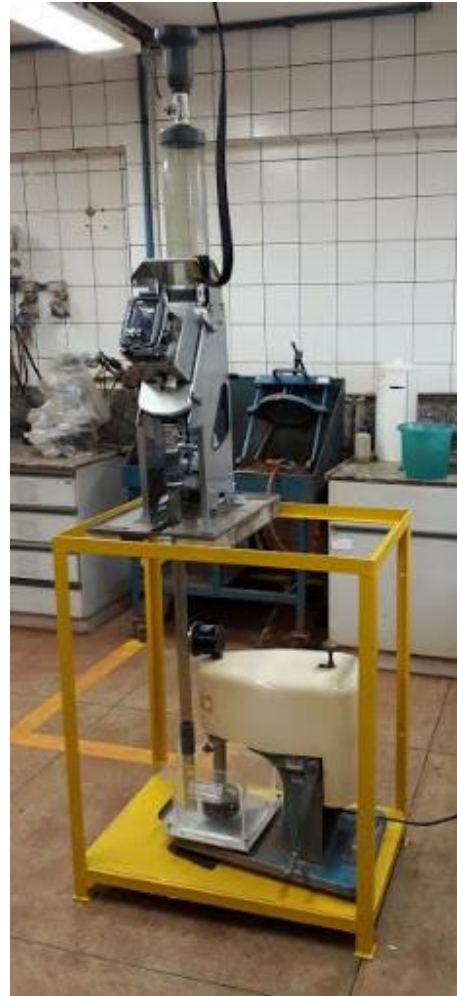
Figura 4. 2 – (a) Medidor de tamanho de bolhas Bubble Sizer APBS. (b) Montagem com o equipamento acoplado à célula de flotação em bancada.
