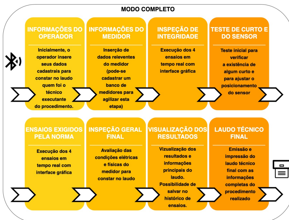
Figura 30 – Fluxograma do funcionamento do aplicativo no modo Completo. Fonte: Autor.
