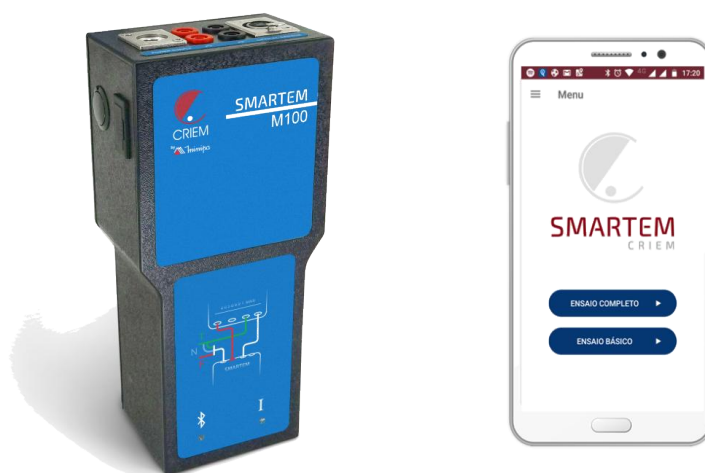
Figura 12 – Equipamento Smartem M100 e aplicativo para celular ou tablet. Fonte: Autor.
