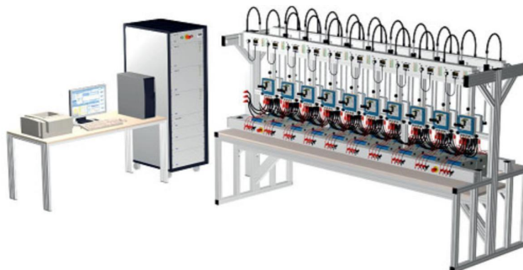
Figura 9 – Bancada de Ensaio de Medidores de Energia de 10 posições. Fonte: Metrum
