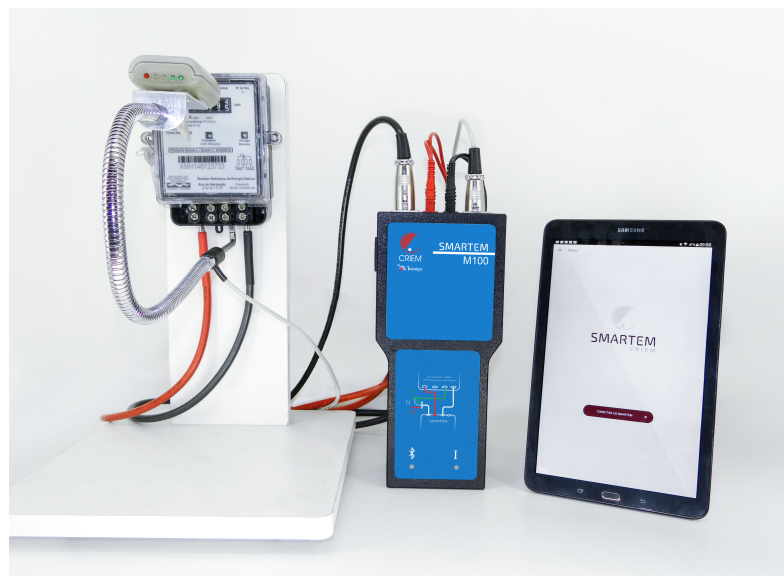
Figura 42 – Smartem conectado a um medidor monofásico de energia e um tablet com o aplicativo aberto na página inicial. Fonte: Autor.
