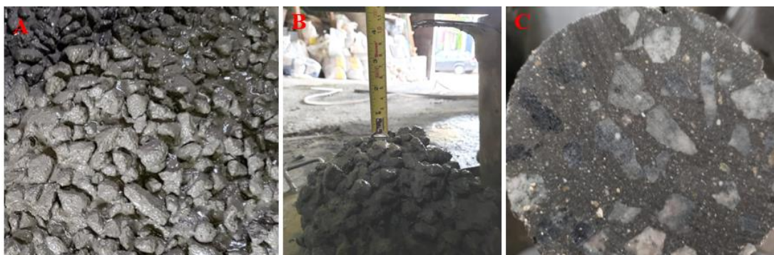
Figura 22: Aspecto e trabalhabilidade do concreto – dosagem 1 (Fonte: o próprio autor)
