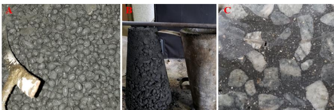
Figura 23: Aspecto e trabalhabilidade do concreto – dosagem 2 (Fonte: o próprio autor)
