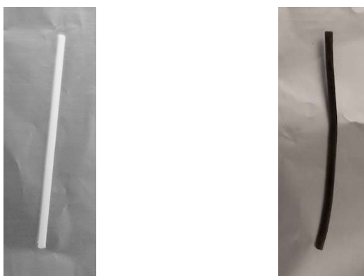
Figura 13. Fotografia da fibra oca de polipropileno não recoberta (HF) e da fibra recoberta com óxido de grafeno (GO-HF)
