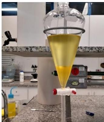
**Figura 4.8** – Resultado da reação de transesterificação: formação do biodiesel (fase menos densa) e da glicerina como subproduto (fase mais densa).
