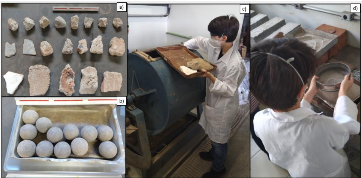
Figura 4.10 - (a) Amostra seca; (b) Esferas utilizadas; (c) inserção das amostras na máquina de Los Angeles e (d) amostra peneirada após o ciclo.
