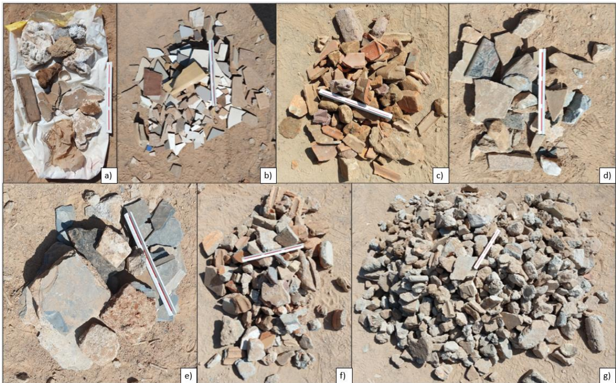
Figura 4.5 - Separação por tipologia durante ensaio de composição gravimétrica (a) Rejeito; (b) Azulejos; (c) Cerâmicos; (d) Rochas Ornamentais; (e) Misto Cinza; (f) Misto Cerâmico e (g) Concretos.
