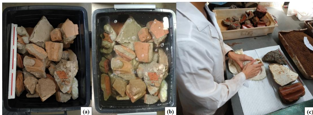
Figura 4.8 – (a) Inserção da amostra no recipiente plástico; (b) Amostras submersas e liberação de bolhas e (c) Amostras sem excesso de água e retirada do excesso de água
