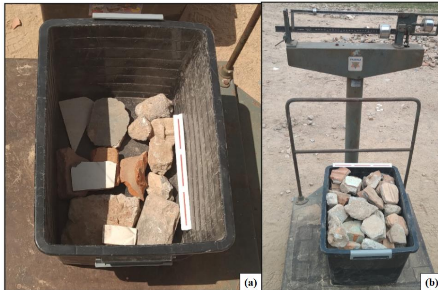
Figura 4.7 - (a) Início da montagem destacando o encaixe dos AR e (b) Caixa totalmente preenchida com a amostra
