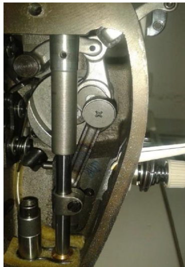
FIGURA 6 - Mecanismo de máquina de costura estica fio e movimentação da agulha. Fonte: Najlawi et al. (2019)
