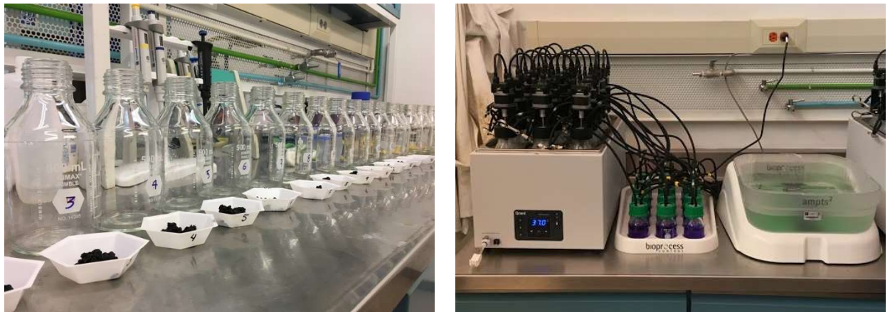
Figura 5-4 – Montagem do teste de BMP da biomassa algal após hidrólise enzimática com conteúdo ruminal e equipamento automático utilizado para o teste.
