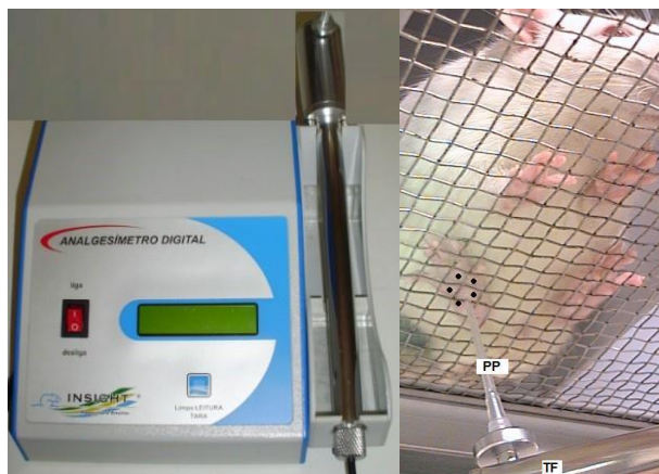
Figura 8 – Aparato utilizado para a avaliação da alodínia mecânica. PP - ponteira de polietileno; TF - transdutor de força. O sítio de estimulação é o centro delimitado pelos pontos pretos.
