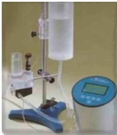
Figura 6 – Pletismômetro: aparato utilizado para a avaliação do edema de pata.
