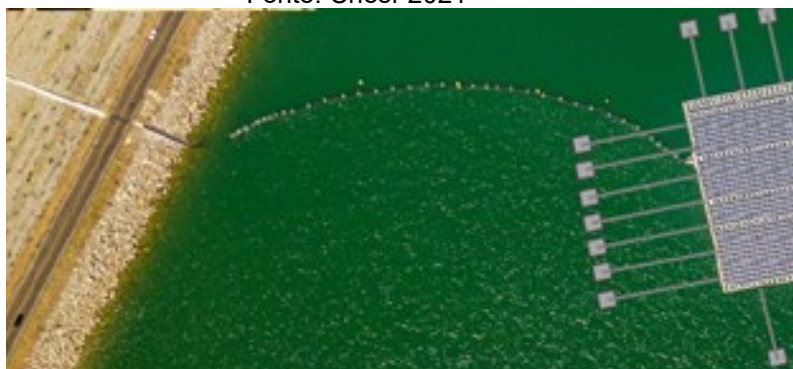
Figura 20: Cabeamentos flutuando sobre a superfície da água – Instalação no lago da represa Sobradinho – UFV 1.000 kWp.
