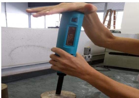
Figura 13: Ensaio com esclerômetro realizado no laboratório.
