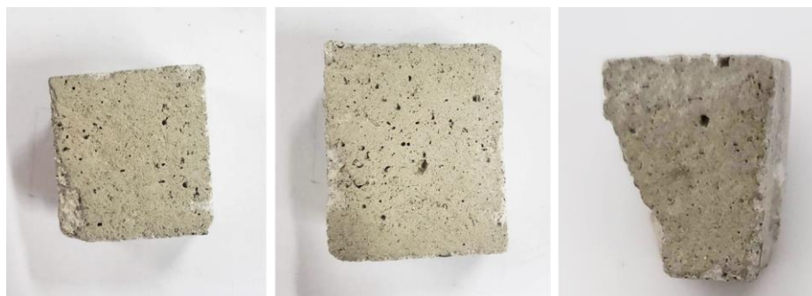
Figura 11 – Amostras para análise de rugosidade superficial
