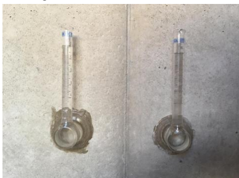
Figura 9 – Tubo de Karsten na Parede de Concreto
