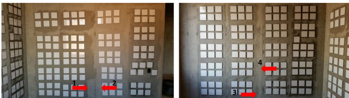
Figura 10 - Pontos de realização do teste de absorção com cachimbo
