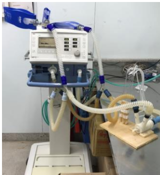
Figura 3 – Montagem do circuito no ventilador mecânico.
