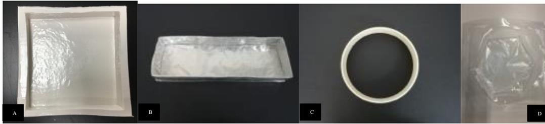
**Figura 12.** Imagens dos moldes utilizados para a produção dos protótipos, (A) silicone (B) Papelão coberto alumínio (C) Aro de PVC (D) PET, Plástico termoformado
