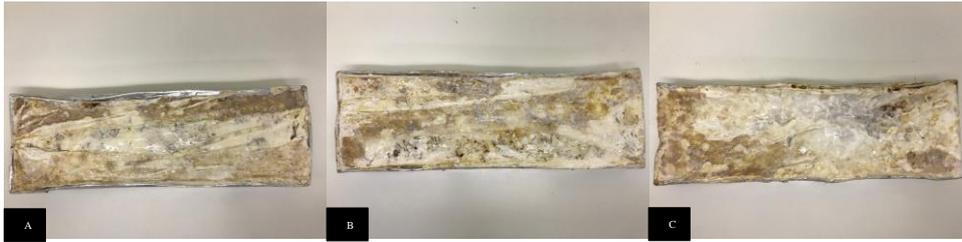
**Figura. 16** Imagens dos protótipos produzidos para o teste de flexão; (A) do micocompósito puro, grupo controle sem aditivo; (B) do micocompósito com rejeito de mineração, relação 0,5/1 (T2); (C) com rejeito de mineração relação 2/1 (T3), quando utilizado o isolado CCMB601
