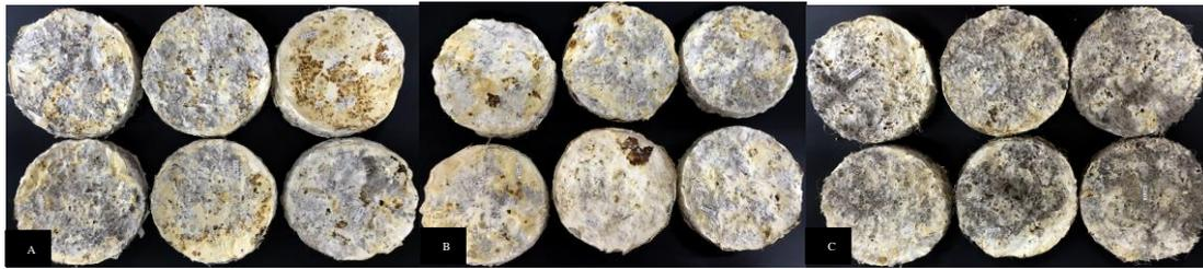
**Figura. 14** Imagens dos protótipos produzidos para o teste de compressão; (A) do micocompósito puro, grupo controle sem aditivo; (B) do micocompósito com filito, relação 0,5/1 (T2); (C) com filito relação 2/1 (T3), quando utilizado o isolado CCMB601
