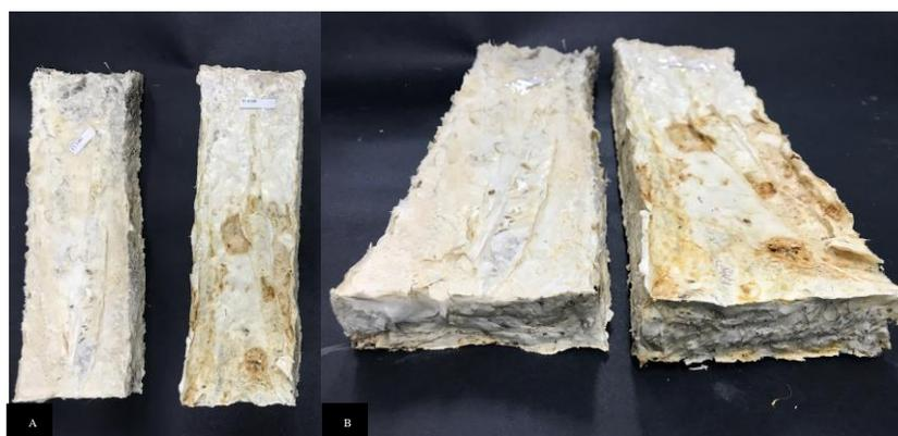
**Figura. 11** Imagens dos protótipos produzidos para o teste de flexão compostos pelo isolado CCMB601 e o aditivo rejeito de mineração; (A) vista da cara superior do micocompósito; (B) vista da cara lateral do micocompósito
