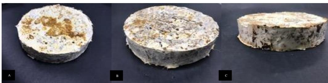
**Figura. 10** Imagens dos protótipos produzidos para o teste de compressão compostos pelo isolado CCMB601 e o aditivo filito; (A) vista da cara superior do micocompósito; (B) vista da cara inferior do micocompósito; (C) vista da cara lateral do micocompósito
