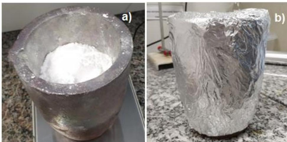
Figura 12 – a) Melamina em um crisol; b) Crisol selado com papel alumínio para ir à estufa
