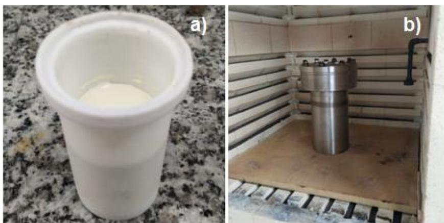
Figura 16 – a) Material parcialmente esfoliado; b) Autoclave
