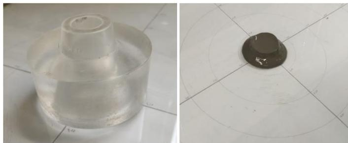
Figura 25 – Ensaio de miniabatimento cone de Kantro
