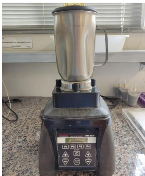
Figura 21 – Aparelho (*mixer*) utilizado para mistura das pastas
