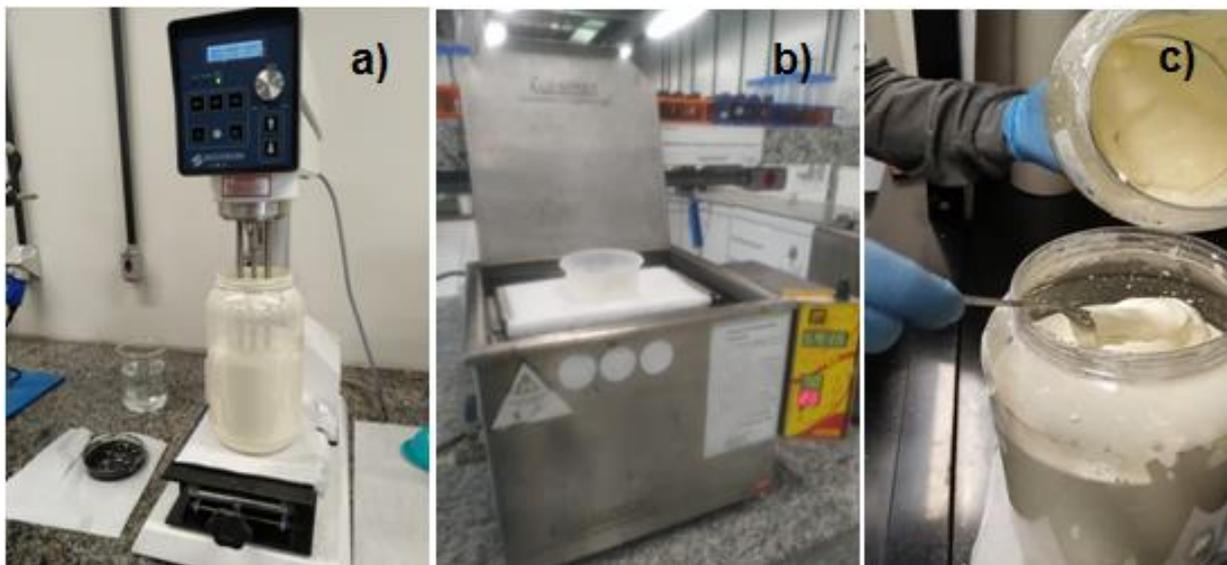
Figura 17 – a) Esfoliação hidrodinâmica; b) Banho ultrassônico; c)  $g-C_3N_4$
