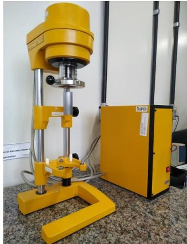
Figura 22 – Reômetro rotativo
