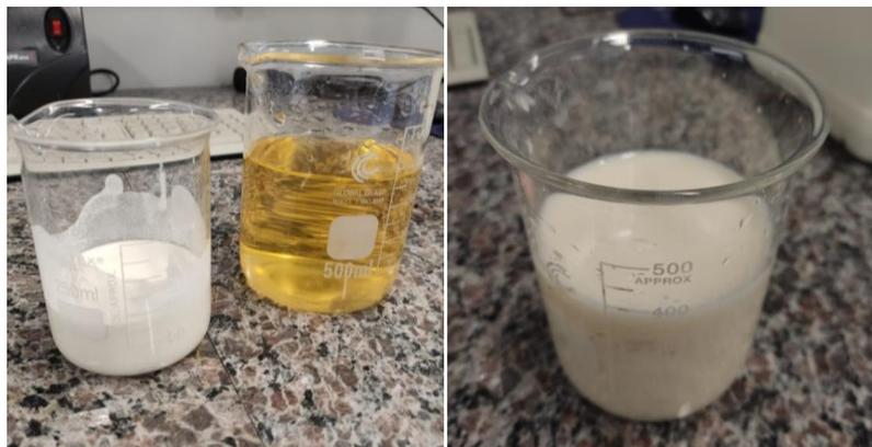
Figura 19 – Processo de preparação do  $g\text{-C}_3\text{N}_4$  para incorporação nas pastas
