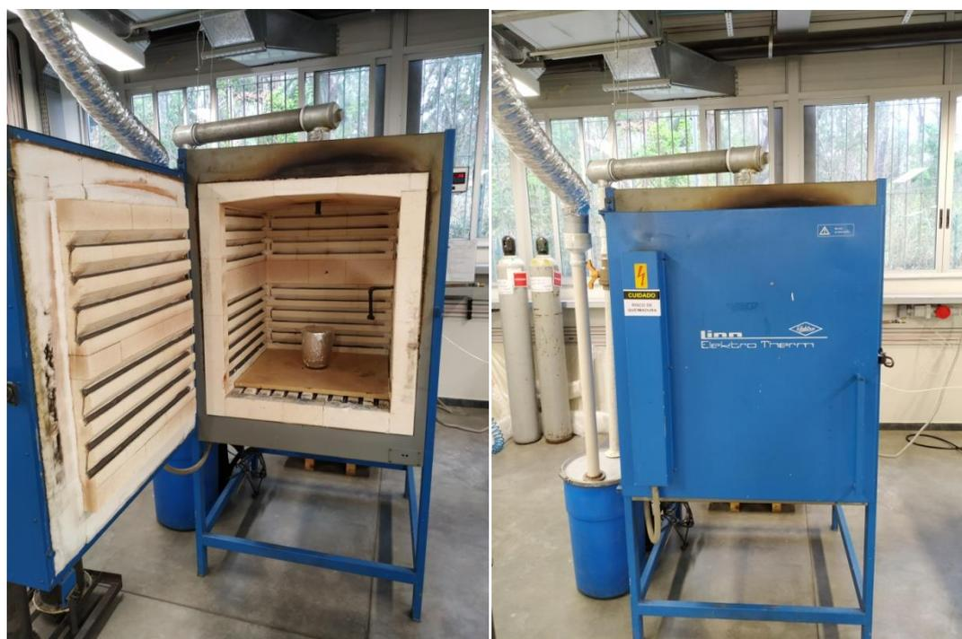
Figura 13 – Estufa utilizada para síntese do g-C<sub>3</sub>N<sub>4</sub>
