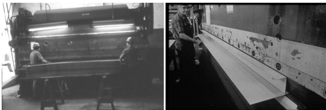
Figura 2- Fabricação de perfis formados a frio por prensa dobradeira
