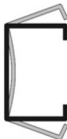
Figura 4- Flambagem por Distorção. Fonte: SILVA et al., 2014.
