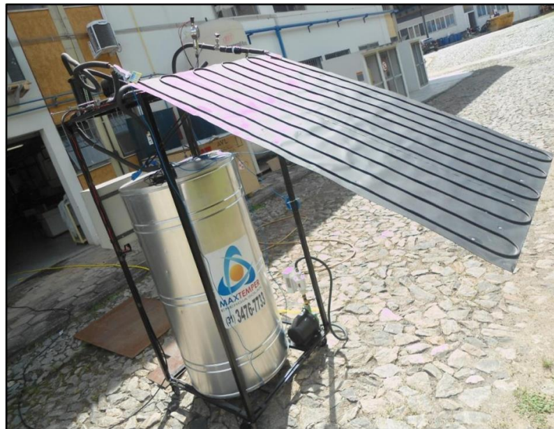
Figura 3.1 – Bomba de calor - GREA – UFMG.
