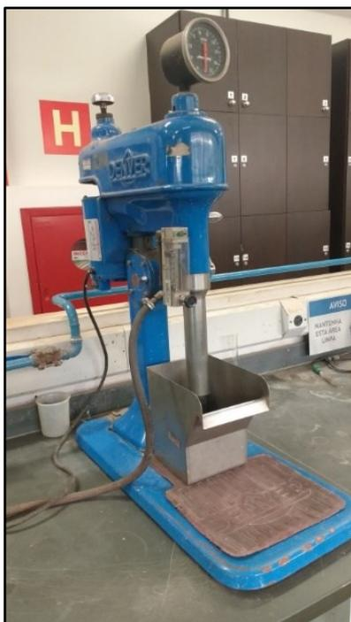
**Figura 4-17: Célula de flotação utilizada nos testes de flotação.**
