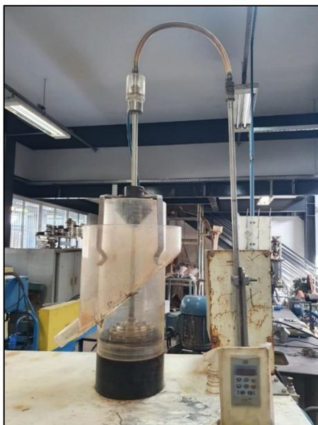
**Figura 4-24: Célula Pneumática "Pneufлот®" utilizada nos testes.**
