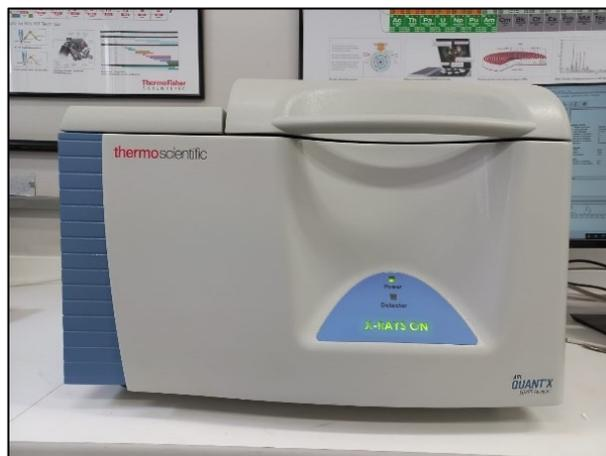
**Figura 4-12: Espectrômetro de fluorescência de raios X utilizado para a quantificação das amostras.**
