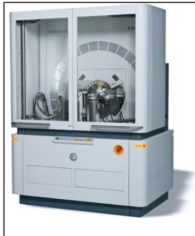
**Figura 4-10: Equipamento utilizado para a realização dos testes de Difratomia de Raios-X.**
