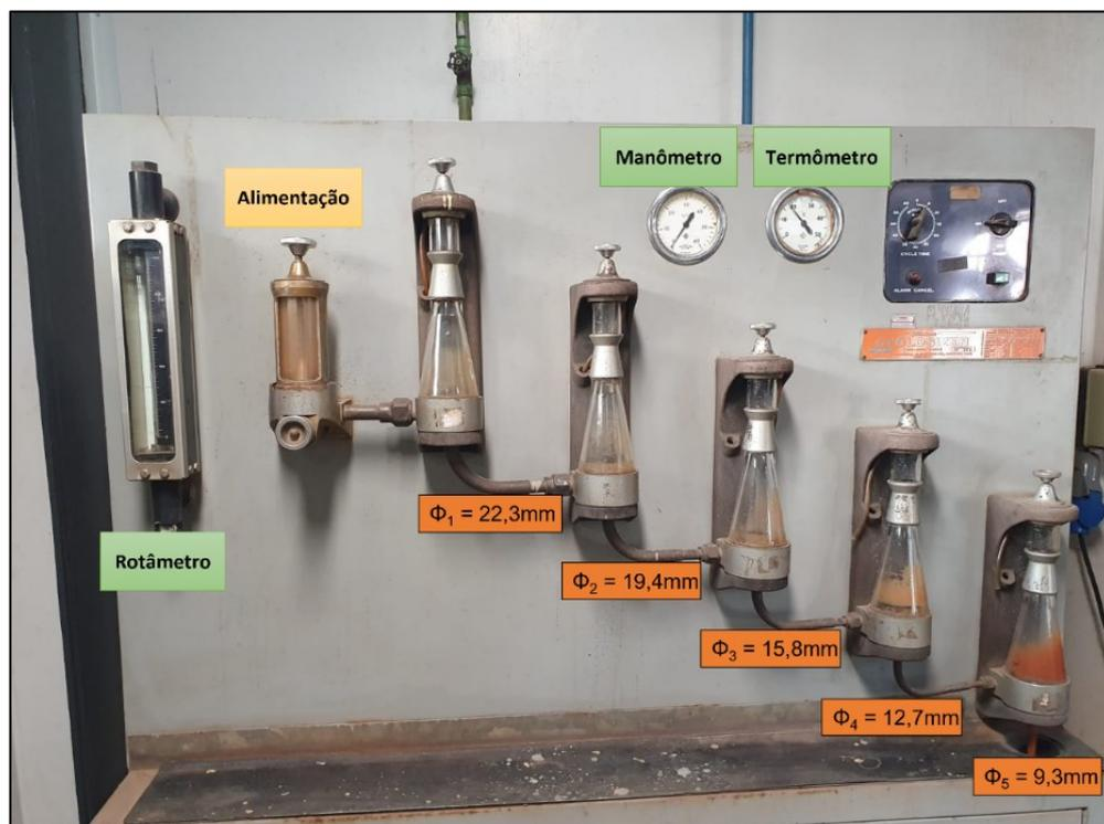
Figura 4-4: *Cyclosizer* utilizado para os testes.
